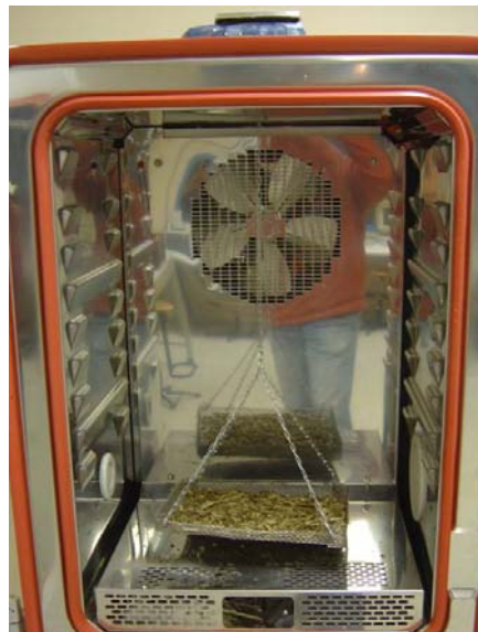
Figure 65 : Dispositif expérimental de séchage en enceinte climatique.
