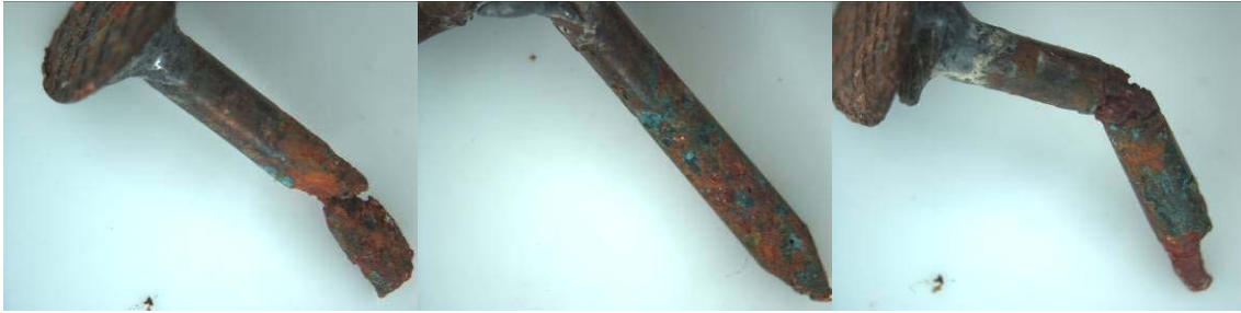
Figure 30 : Pointes en cuivre après séchage en tas de plaquettes forestières
