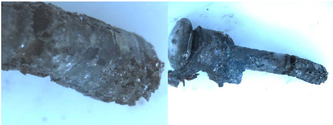
Figure 57 : Pointe inox dégradée suite à l'essai
