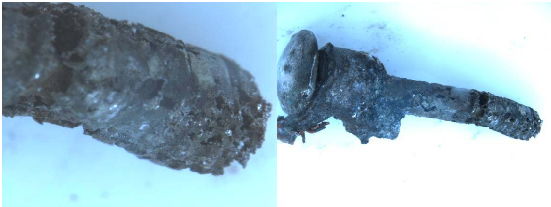
Figure 57 : Pointe inox dégradée suite à l'essai
