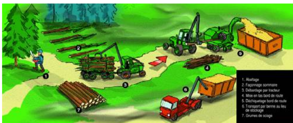
Figure 5 : Étapes de la production des plaquettes forestières
