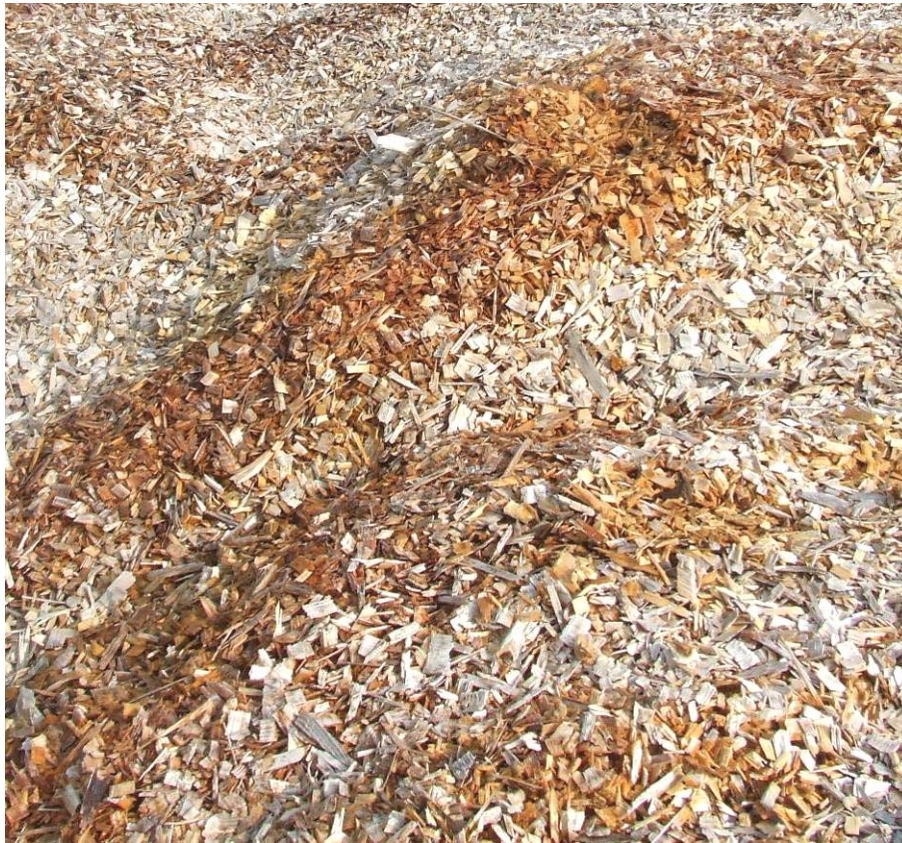
Figure 52 : Essai 4 – cheminées d'évacuation de vapeur d'eau
