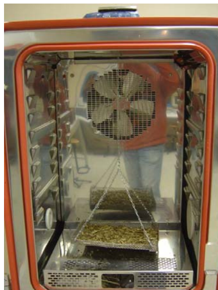
Figure 65 : Dispositif expérimental de séchage en enceinte climatique.
