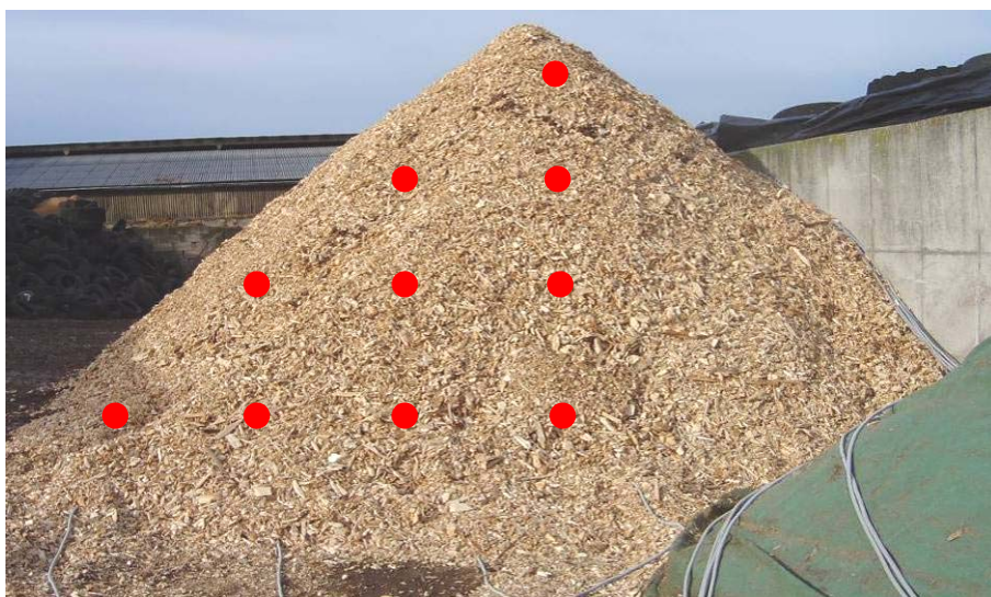
Figure 40 : Exemple de tas de plaquettes forestières instrumenté
