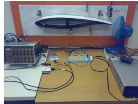
(b) Profil d'aile d'avion adaptatif [Ahola 2008]
