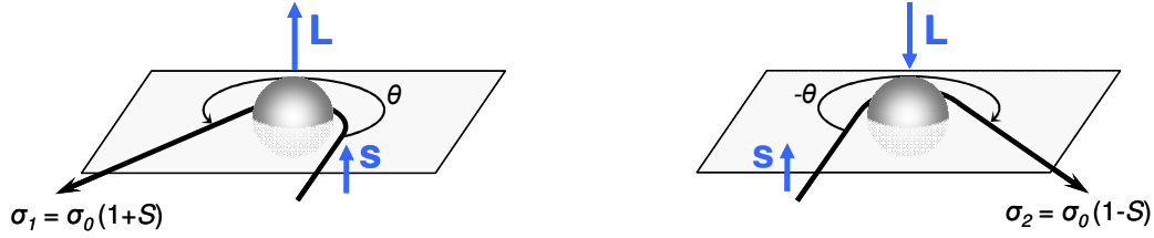
Fig. V-12 – Diffusion de Mott sur un noyau lourd. Le couplage spin-orbite favorise un alignement parallèle du spin s de l'électron avec le moment cinétique L de sa trajectoire. Pour un angle \theta donné, l'asymétrie de diffusion est caractérisée par la fonction de Sherman S .
