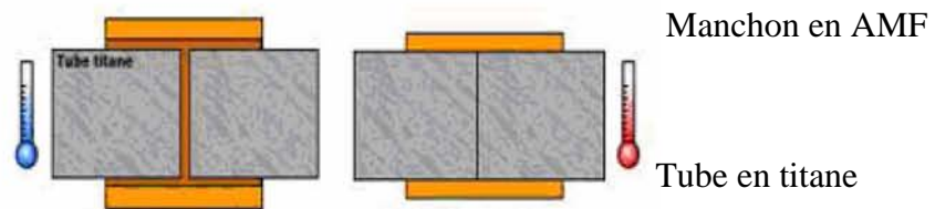
Figure I-3 : Accouplement de tube en titane [8]
