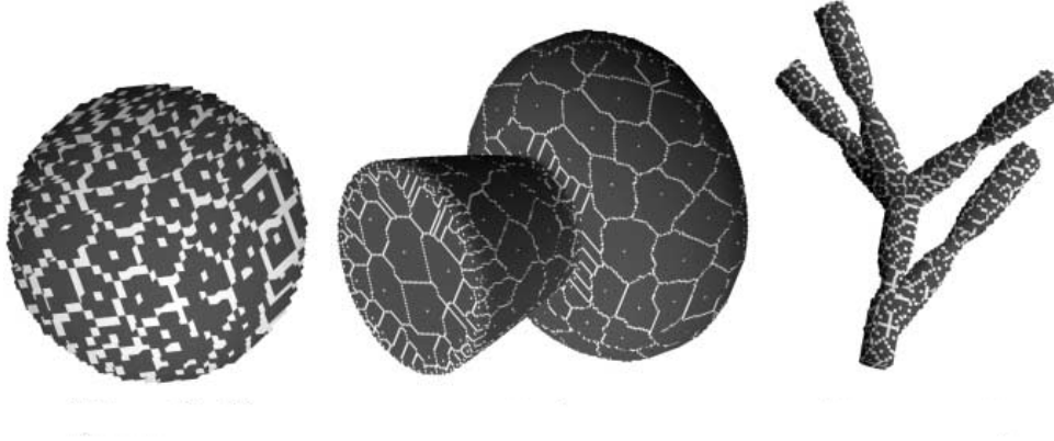
Figure 2.5 – Squelettisations de la surface d'objets, relativement aux graines choisies (en blanc), qui représentent des diagrammes de Voronoï discrets topologiques (source [BM03]).
