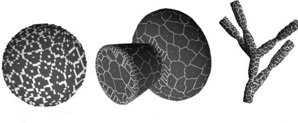
Figure 2.5 – Squelettisations de la surface d'objets, relativement aux graines choisies (en blanc), qui représentent des diagrammes de Voronoï discrets topologiques (source [BM03]).
