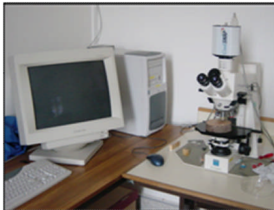
figureIV.3 : Schéma du dispositif d'acquisition des images optiques
