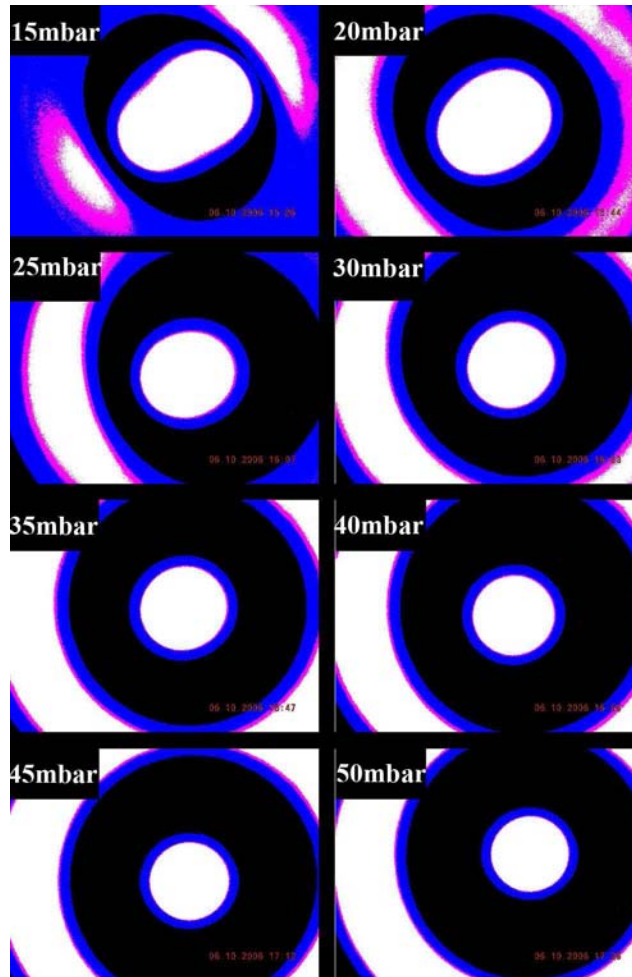
Figure II-5 : Photographies du plasma prises à travers le hublot du réacteur montrant la variation du volume du plasma d'hydrogène en fonction de la pression du gaz introduit. La puissance est fixée à 250W.
