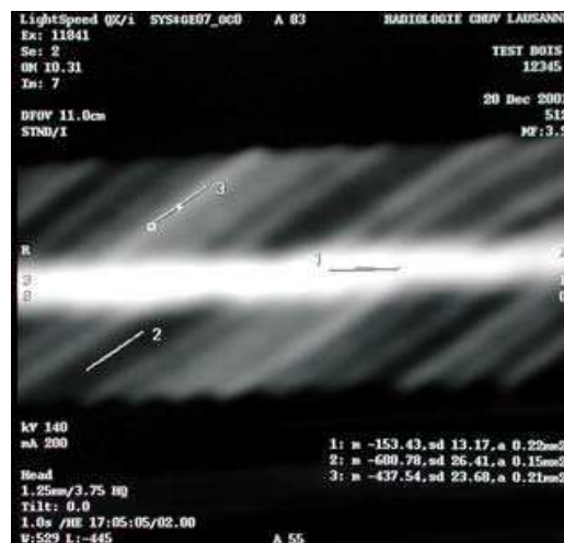
Figure 47: Image obtenue par tomographie pour un échantillon soudé. La zone de contact apparaît sous la forme d'une raie lumineuse au milieu (ILLING, 2002)
