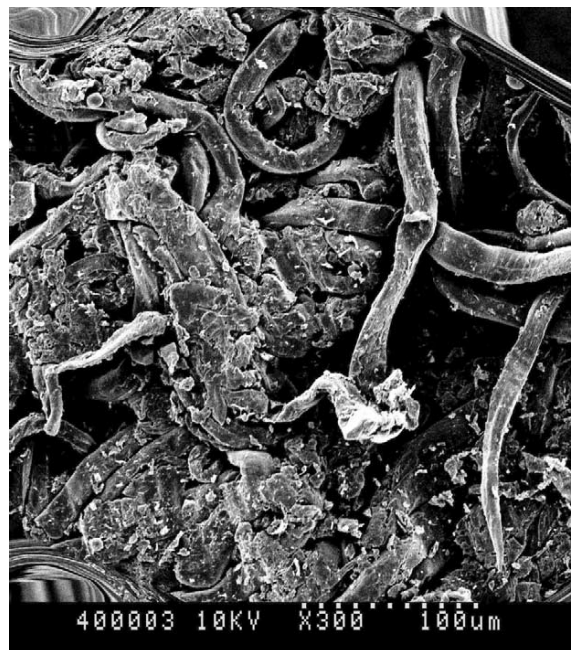
Figure 46 : Image de microscopie électronique à balayage de l'interface soudée ouverte mettant en évidence l'existence d'un réseau de fibres de bois enchevêtrées et bloquées dans une matrice durcie de matériel inter-cellulaire (Gfeller et al. 2003).
