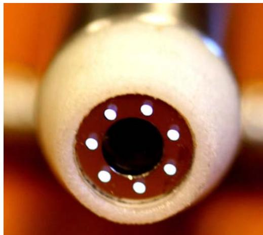
**Figure E.** Vue de la partie proximale du stylo optique. On distingue les 7 entrées de réception de lumière placées autour d'un disque interne (noir sur la photo) par lequel est transmise la lumière collimatée d'excitation.
