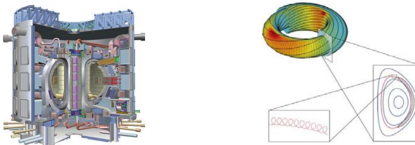
FIG. 1: figure de gauche - Vue artistique du tokamak expérimental ITER. figure de droite - Configuration d'un tokamak : les lignes de champ magnétique s'enroulent en hélice sur des surfaces magnétiques imbriquées en couches superposées (en haut). Dans une vue en coupe (en bas à droite), les trajectoires des particules, l'une piégée (en noir), l'autre passante (en rouge), dérivent hors des surfaces magnétiques (en bleu), mais restent confinées. Une vue de détail (en bas à gauche) montre la trajectoire d'une particule [1].
