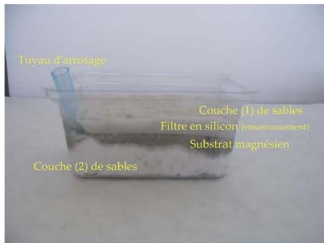
Figure II-12. Dispositif de croissance des plantes (production de biomasse) sur substrat minéral.
