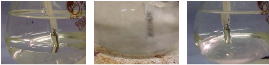
FIG. 1.8 – Mélange de méthanol ( \text{CH}_3\text{OH} ) et d'hexane ( \text{C}_6\text{H}_{14} ) dans les proportions de molécules 0.435 : 0.665. De gauche à droite, T < T_c , T \approx T_c et T > T_c . Pour T < T_c un ménisque sépare les composés qui ne sont pas miscibles. Pour T > T_c les composés sont miscibles et forment une seule phase. Pour T \approx T_c , le mélange devient flou. Les fluctuations de la densité entraînent une variation de l'indice de réfraction : les rayons lumineux sont déviés [Phys].
