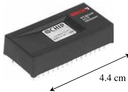
Figure III.3 : Photographie d'un composant SC- 13, Beck IPC GmbH
