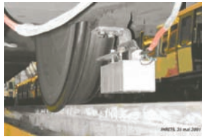
FIG. 1.5 – Le capteur à courants de Foucault monté sur une voiture d'inspection [Aknin et al., 1992]
