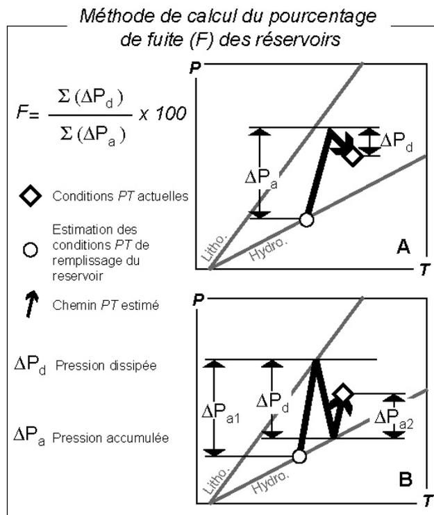
**Figure 6.11. Méthode de calcul du pourcentage de fuite (F) d'un réservoir basée sur les reconstructions PVTX.**
