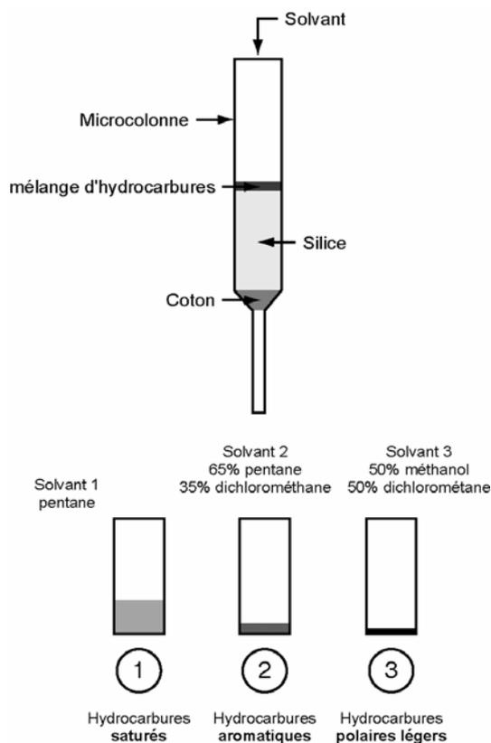
**Figure 3.7. Protocole de fractionnement sur colonne de silice.**
