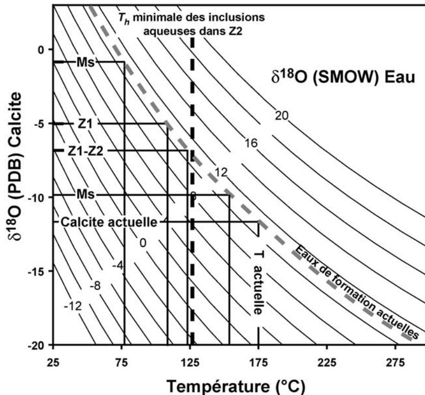
Figure 6.4. Diagramme des  $\delta^{18}\text{O}_{\text{PDB}}$  de la calcite en fonction de la température de précipitation rassemblant plusieurs courbes de valeur de  $\delta^{18}\text{O}$  de l'eau parente (SMOW) calculées d'après l'équation de fractionnement de Kim & O'Neil (1997). Cette équation est valable sur la gamme de température 25-350°C. Ms : microsparite ; Z1 : zone 1 ; Z2 : zone 2.
