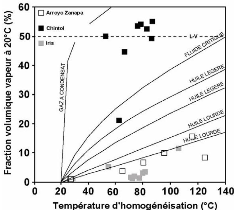
Figure 5.61. Diagramme des fractions volumiques vapeur ( $\phi_{\text{vap}}$ ) à 20°C en fonction des températures d'homogénéisation des inclusions hydrocarbonées mesurées dans les échantillons du secteur Chintol, Iris et Arroyo Zanapa. L-V : ligne séparant les homogénéisation en phase liquide (sous la ligne) des homogénéisation en phase vapeur (au dessus de la ligne).
