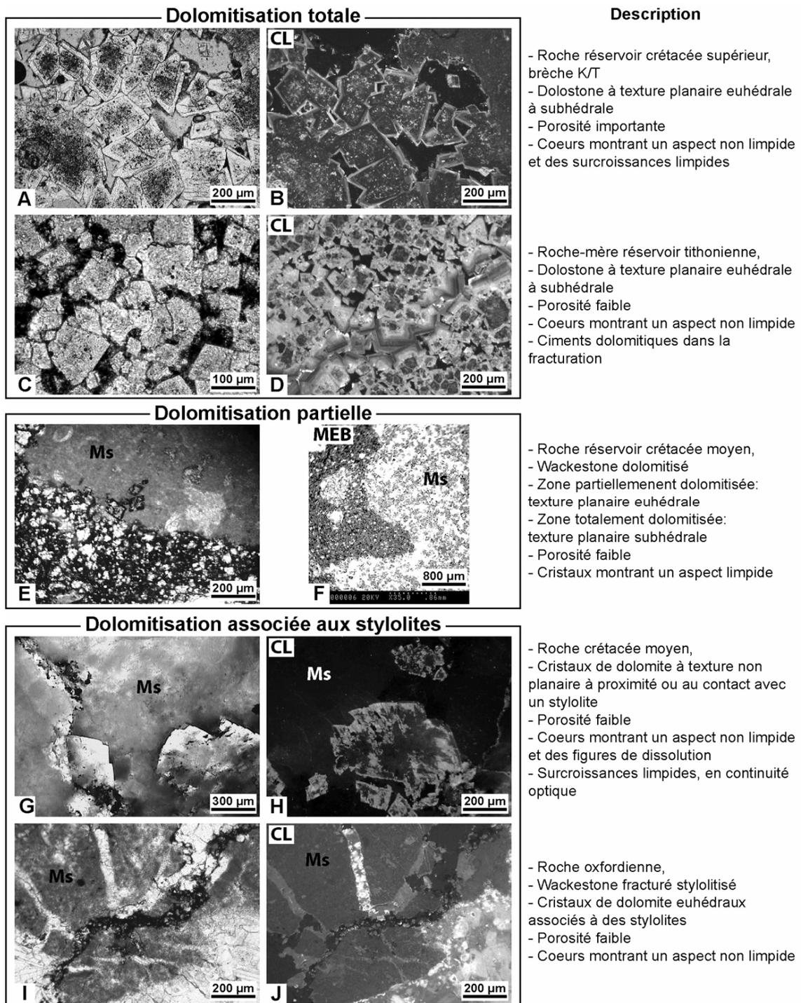
Figure 6.1. Photographies en lumière naturelle, CL et MEB des textures des roches dolomitisées, montrant une dolomitisation totale, partielle ou locale, alors associée aux stylolites. Les images en vis-à-vis C-D, E-F et G-H ne sont pas superposables. Ms : Microsparite.
