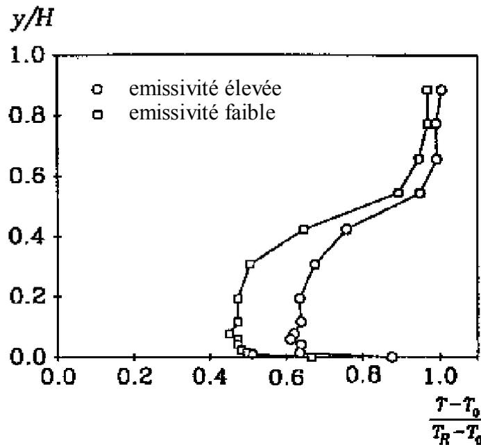
Figure 2.6 : Influence de l'émissivité de la source sur le profil vertical de température (d'après Nielsen [24])
