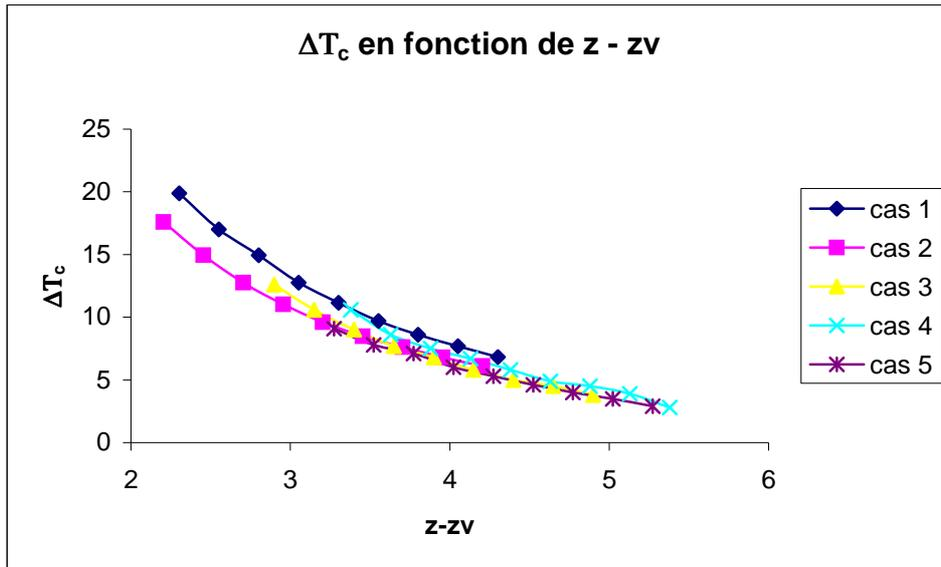
figure 5.13 : Evolution de la température au centre du panache en fonction de z-z<sub>v</sub> pour les cinq cas étudiés
