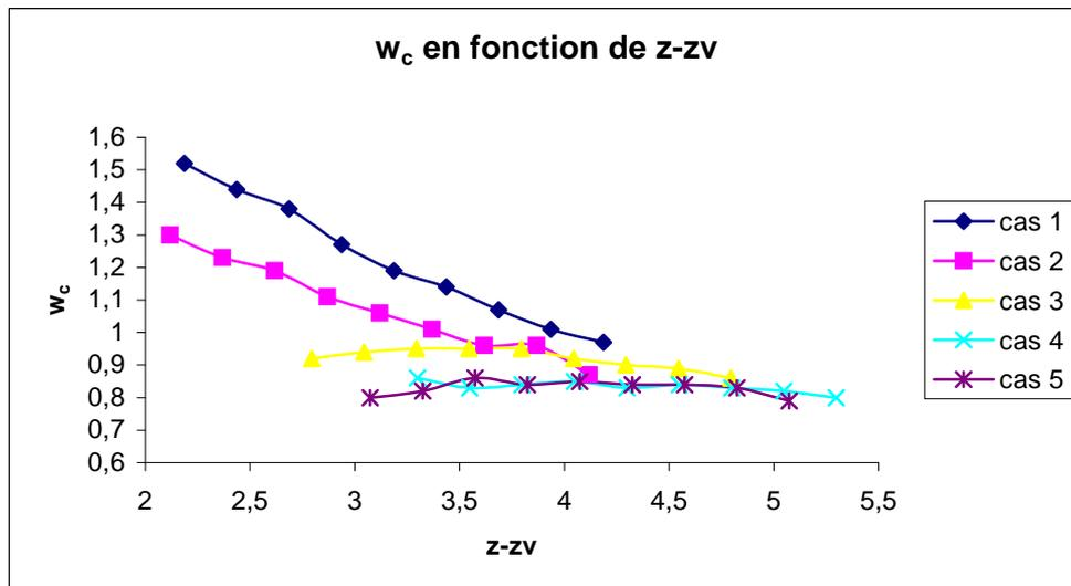
figure 5.14 : Evolution de la vitesse au centre du panache en fonction de z-z<sub>v</sub> pour les cinq cas étudiés
