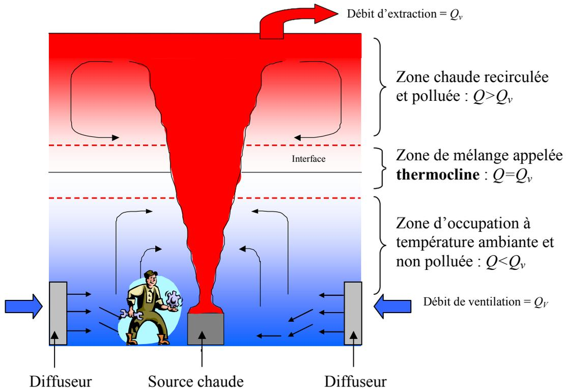
Figure 2.1 : Principe de la ventilation par déplacement
