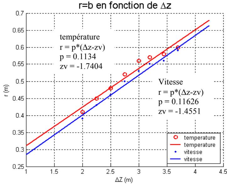
Figure 5.48 : Evolution des rayons thermiques et dynamiques en fonction de  $z > 2\text{m}$  - Comparaison des origine virtuelles : 1 source
