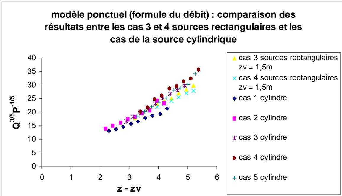
figure 5.72 : modèle ponctuel : comparaison des résultats entre les cas 3 et 4 sources rectangulaires et les cas de la source cylindrique à partir de la formule du débit  $Q(z) = 0,005.P_c^{1/3}(z - z_v)^{5/3}$
