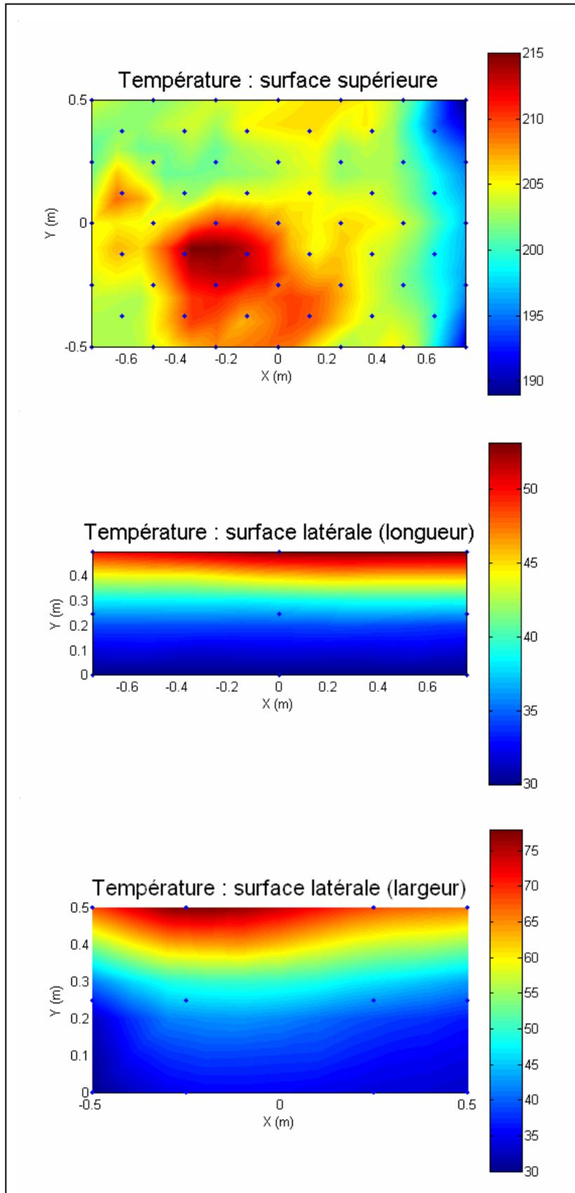
Figure 4.8 : Températures de surfaces de la source rectangulaire
