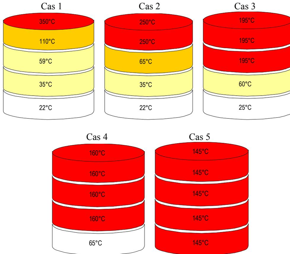
figure 5.1 : configuration de la source pour les cas 1, 2, 3, 4, 5
