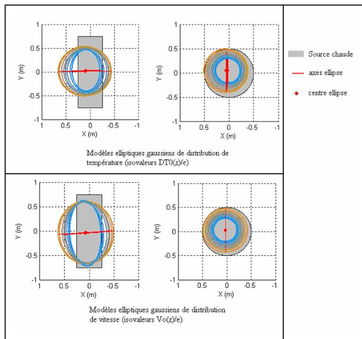
figure 5.71 : comparaison des modèles elliptiques gaussiens de distribution de température et de vitesse obtenus pour la source rectangulaire et la source cylindrique à  $z = 1,25, 1,50, 1,75, 2,25, 2,5 \text{ m}, 2,75, 3 \text{ m}$  et  $3,25 \text{ m}$
