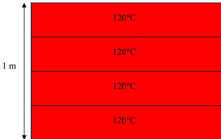
figure 5.39 : configuration des 4 sources rectangulaires (vue de dessus)
