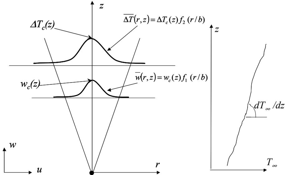
Figure 2.2 : Représentation schématique d'un panache axisymétrique
