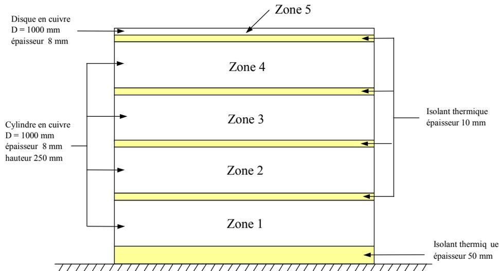
Figure 3.5 : Schéma de la source cylindrique utilisée
