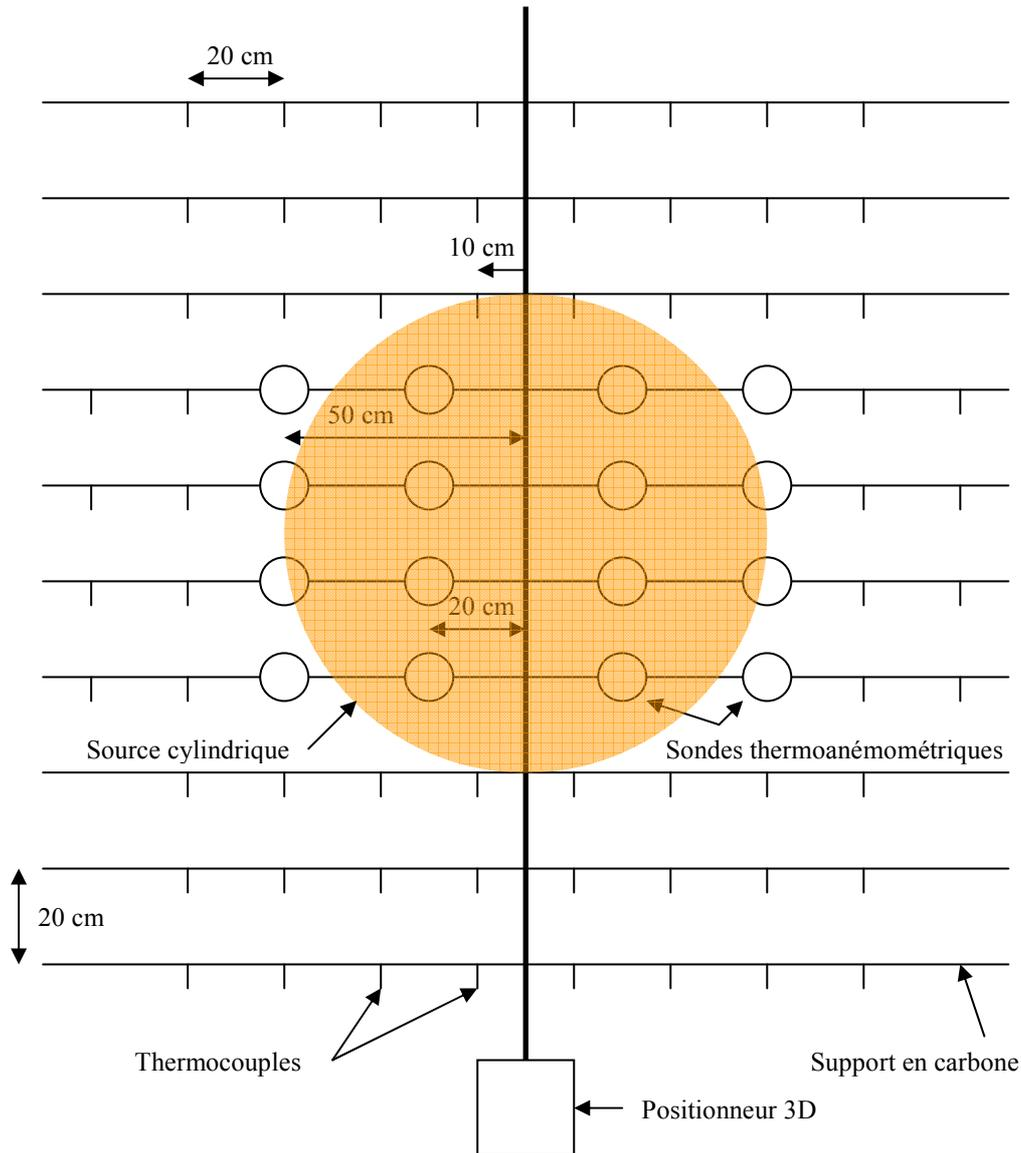
Figure 4.3 : Disposition des thermocouples et des sondes thermoanémométriques (vue de dessus)
