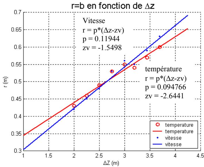
Figure 5.49 : Evolution des rayons thermiques et dynamiques en fonction de  $z > 2\text{m}$  - Comparaison des origine virtuelles : 2 sources
