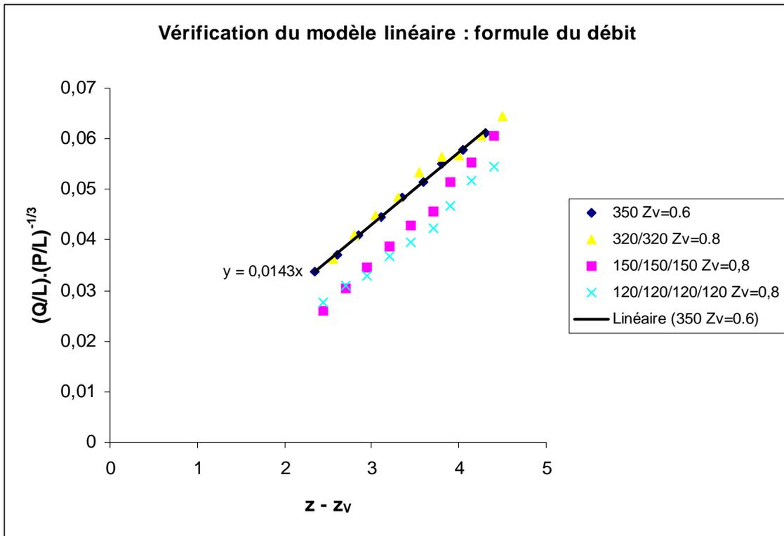
figure 5.50 : vérification du modèle linéaire à partir de la formule du débit
