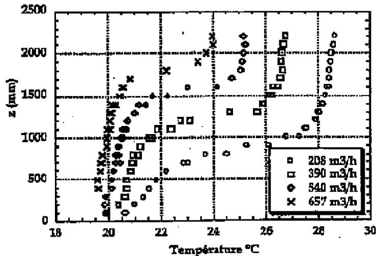
Figure 2.7 : Exemples de profils verticaux de température mesurée en enceinte aéraulique pour différents débits de ventilation dans le cas d'un jet d'air chaud (d'après Pinard et al. [23])
