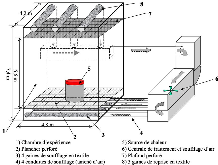
Figure 3.1 : Schéma de la cellule aéraulique installée à l'INRS
