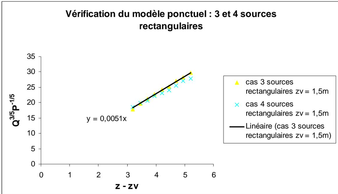
figure 5.51 : vérification du modèle ponctuel à partir de la formule du débit  $Q(z) = 0,005.P_c^{1/3}(z - z_v)^{5/3}$  : 3 et 4 sources rectangulaires
