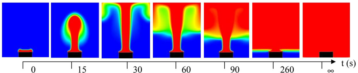
Figure 2.14 : Evolutions du champ de température de l'air environnant dans une enceinte cylindrique ( $R=2,5m$  et  $H=5m$ ) avec une source thermique de  $1.54m$  de diamètre à  $200^{\circ}C$
