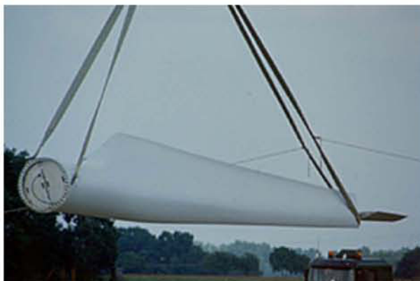
FIG. 1.12 – Pales d'une éolienne avec système de freinage en bout.
