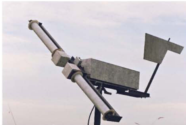
FIG. 1.13 – Prototype d'éolienne à rotor de FLETTNER.
