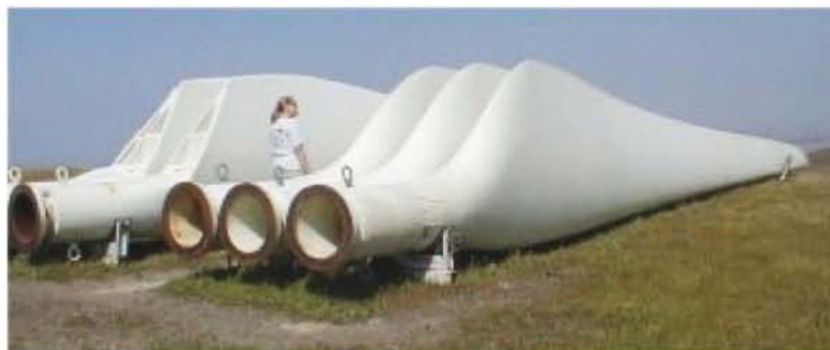
FIG. 2.1 – Pale d'éolienne : affinement du profil et vrillage.
