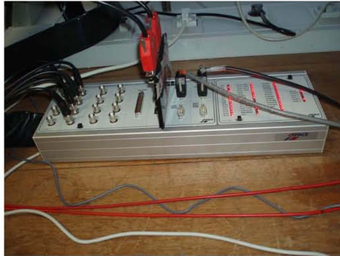
Figure IV.9. Photo du dispositif incluant les cartes externes du Dspace.
