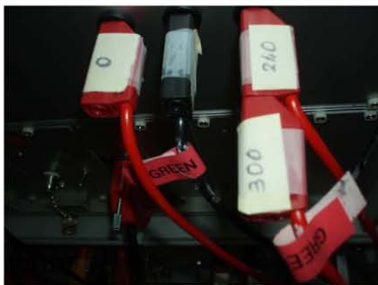
(a) La troisième phase du premier onduleur partagée par les troisième et sixième phases de la machine.
