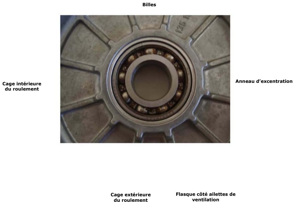
Figure IV.1. Photo illustrant l'insertion d'un anneau non uniforme entre la flasque et le roulement à billes présentant un jeu de contact [8].
