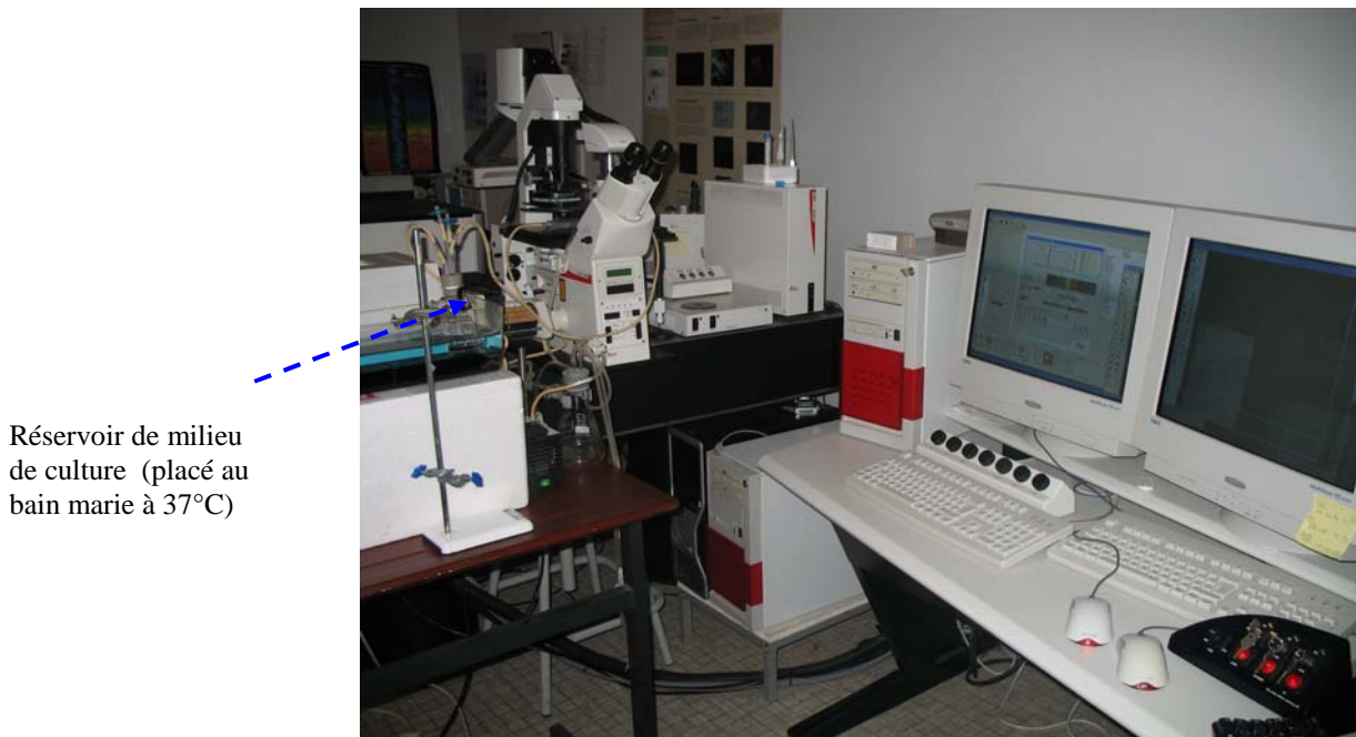
Figure-II.7A-B-C : Montage de la chambre de flux sur la plate-forme du microscope de fluorescence confocale (Leica SP2-AOBS, Germany) : Lasers utilisés (Arg 488 nm, HeNe 543 nm). A : montage vu de derrière ; B : montage vu de face. C : vu d'ensemble de l'adaptation du système en flux au microscope.
