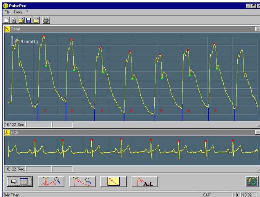
Figure 4: enregistrement de l'onde de pression carotidienne avec le PulsePen®
