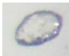
Figure 2.13: Image au microscope optique d'un cristal de mordenite synthétisé sans alcool (la longueur maximale est ~100 µm selon [010])
