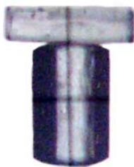
Figure 2.12 : Cristaux de mordenite synthétisés selon le Protocole 1 ( \sim 180 \mu\text{m} \times 120 \mu\text{m} \times 60 \mu\text{m} ).
