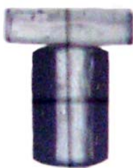
Figure 2.12 : Cristaux de mordénite synthétisés selon le Protocole 1 ( \sim 180\mu\text{m} \times 120\mu\text{m} \times 60\mu\text{m} ).
