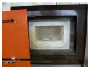
Figure 2.16 : Dispositif de calcination.
