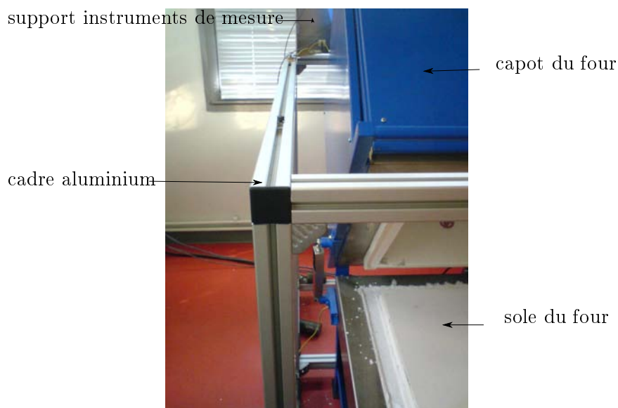
FIGURE 7.7 – Le cadre en profilé aluminium qui sert de châssis
