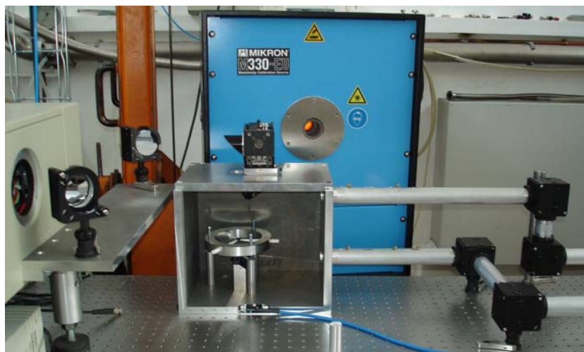
FIGURE E.5 – Photo du dispositif avec le corps noir et le spectromètre
