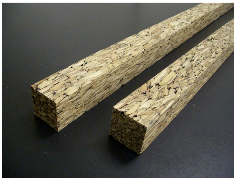
Figure 10 : Panneau collé avec une résine tanin-hexamine.
