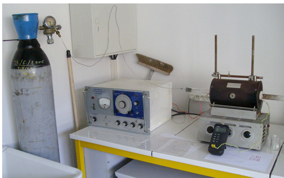
Figure 34 : Système utilisé pour la carbonisation des mousses de tanin
