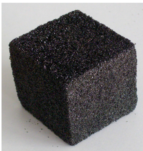
Figure 30 : Mousse de tanin de mimosa ( 0,085 \text{ g/cm}^3 ) et mousse modifiée avec 20% de polyuréthane ( 0,12 \text{ g/cm}^3 ).
