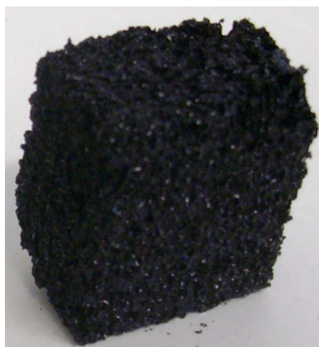
Figure 30 : Mousse de tanin de mimosa ( 0,085 \text{ g/cm}^3 ) et mousse modifiée avec 20% de polyuréthane ( 0,12 \text{ g/cm}^3 ).
