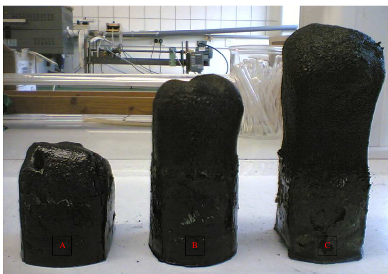
Figure 29 : Mousses de tanin brut à différentes densités : A) 0,12 \text{ g/cm}^3 ; B) 0,085 \text{ g/cm}^3 ; C) 0,05 \text{ g/cm}^3 .
