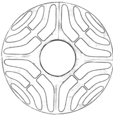
(a) Rotor à barrière de flux [29]
