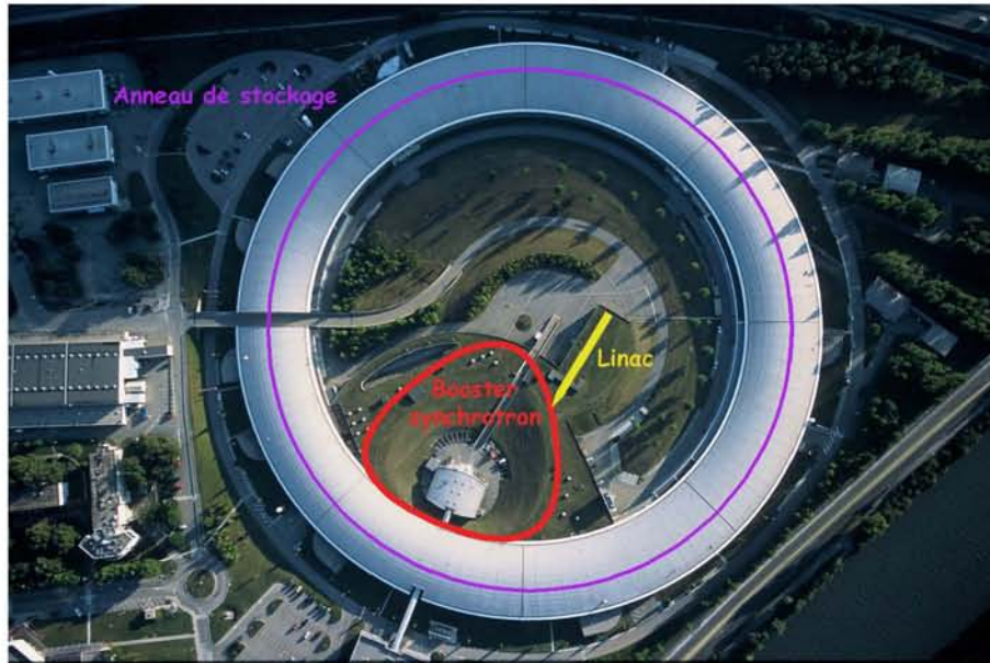
Figure II-4 : Vue aérienne de l'ESRF (European Synchrotron Radiation Facility) de Grenoble. L'anneau de stockage est symbolisé par un cercle mauve, les accélérateurs linéaire et circulaire, symbolisés par une flèche jaune et un anneau rouge respectivement, sont invisibles en surface.
