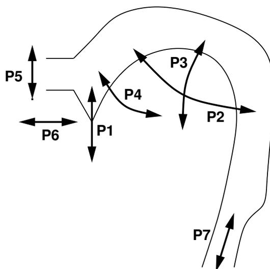
FIG. 1.3: Les sept paramètres du modèle de Maeda : la mâchoire (ou *ju*)  $P1$ , l'ouverture verticale (*lh*)  $P5$  et la protrusion des lèvres (*lp*)  $P6$ , la position du corps de la langue (*tb*)  $P2$ , la forme de la langue (*ts*)  $P3$ , un dernier terme contrôlant la pointe de la langue (*tt*)  $P4$ , et enfin la hauteur du larynx (*lx*)  $P7$ .
