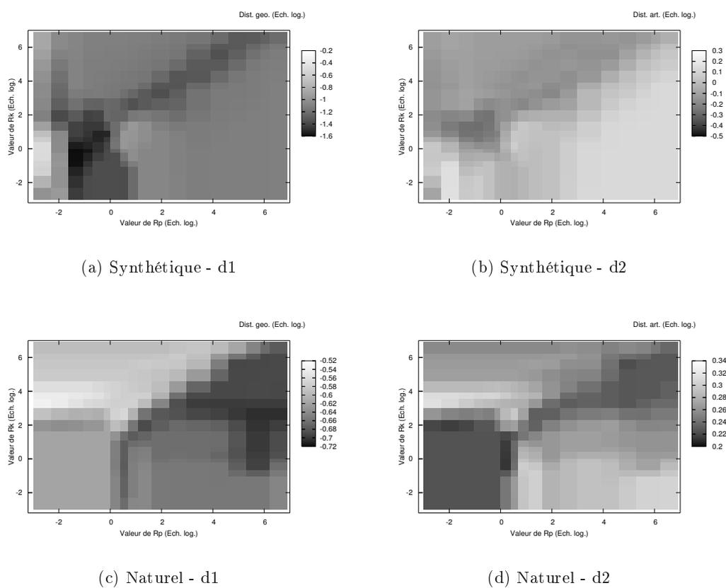
FIG. 6.13: Erreur de la trajectoire articulaire trouvée par lissage non linéaire, en fonction de  $R_p$  et  $R_k$ , pour la séquence /wi/. Échelles logarithmiques. Le dégradé de gris indique la valeur de l'erreur : plus la couleur est sombre, plus l'erreur est faible.
