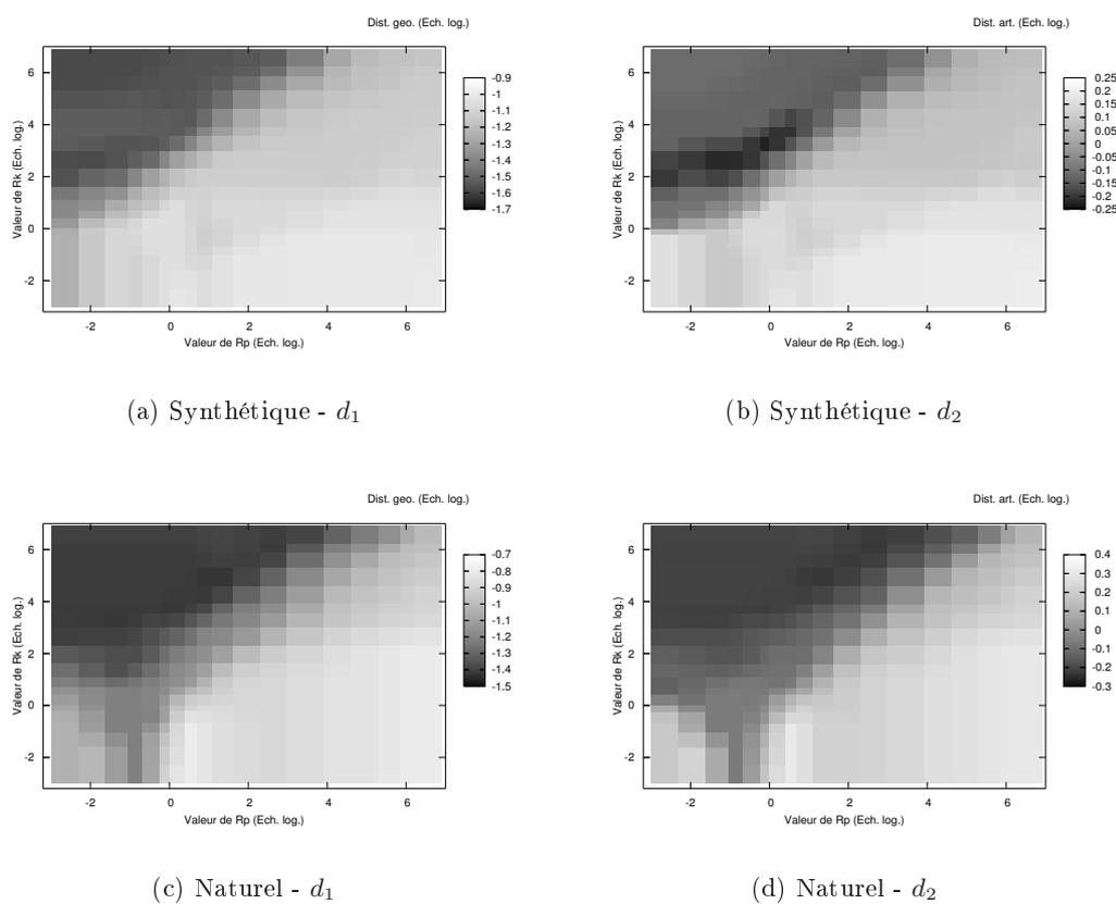
FIG. 6.15: Erreur de la trajectoire articulaire trouvée par lissage non linéaire, en fonction de  $R_p$  et  $R_k$ , pour la séquence / $\eta$ i/. Échelles logarithmiques. Le dégradé de gris indique la valeur de l'erreur : plus la couleur est sombre, plus l'erreur est faible.
