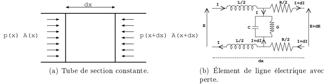
FIG. 1.5: Analogie acoustique  $\leftrightarrow$  électricité.
