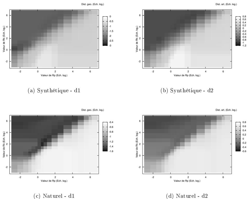
FIG. 6.11: Erreur de la trajectoire articulaire trouvée par lissage non linéaire, en fonction de  $R_p$  et  $R_k$ , pour la séquence /wa/. Échelles logarithmiques. Le dégradé de gris indique la valeur de l'erreur : plus la couleur est sombre, plus l'erreur est faible.
