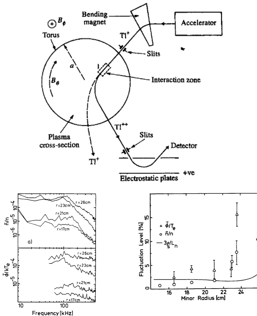
**Fig. B.1 – (haut) :** Schéma de fonctionnement d'un diagnostic HIPB au thallium. Les ions sont accélérés et sélectionnés selon leur énergie ; ils pénètrent le plasma où ils interagissent avec les électrons, modifiant leur charge et ainsi leur trajectoire. Ils atteignent l'analyseur d'énergie électrostatique et le détecteur, où ont lieu les mesures. [Wesson 97]
