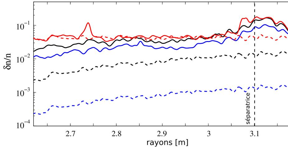
**Fig. 4.31** – TS #38314 - Profils moyens des fluctuations de densité simulées  $\delta n/n(r)_{sim}$ . La 1<sup>re</sup> itération (hypothèse initiale, pointillés épais) et la 5<sup>e</sup> itération (résultat, traits épais) sont tracées pour trois hypothèses initiales sur l'intensité des  $\delta n/n$  : faible (bleu), moyenne (noir), forte (rouge).
