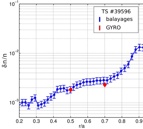
**Fig. 5.2** – Intensité des  $\delta n(r)$  expérimentaux (par réflectométrie à balayage mode X) et simulés (*GYRO*) calculés à partir de l'intégration des modes  $1 \text{ cm}^{-1} \leq k_r \leq 10 \text{ cm}^{-1}$ .
