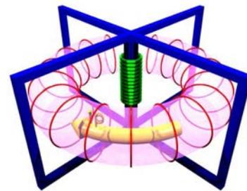
**Fig. 1.2** – Champ poloïdal (en rouge) induit par un courant  $I_p$  circulant dans le plasma (en jaune). Le bobinage du circuit primaire est représenté en vert tandis que le circuit magnétique est en bleu.
