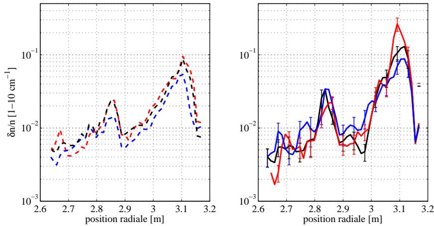
**Fig. 4.37** – TS #38314 - Profils radiaux de fluctuations de densité expérimentaux, intégrés entre 1 et 10  $\text{cm}^{-1}$ , correspondant à la Fig. 4.36. (gauche) : après une itération ; (droite) : après 5 itérations.
