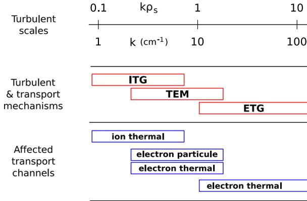
**Fig. 2.9** – Aperçu des différents modes turbulents ainsi que les mécanismes de transports associés, en fonction des échelles spatiales.  $k$  est un vecteur d’onde typique (radial ou poloïdal), et  $\rho_s$  correspond au rayon de Larmor ionique avec  $T_i = T_e$ . Issue de [Group 07]
