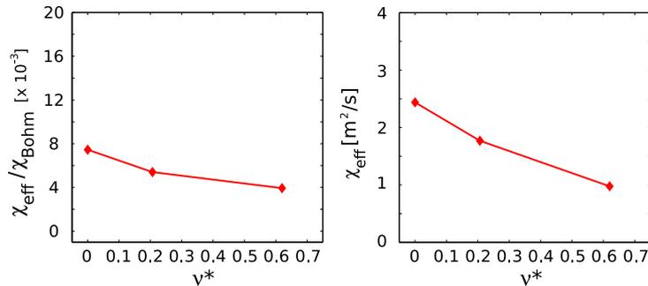
**Fig. 6.13** – (gauche) Coefficient de diffusivité thermique effective normalisé au coefficient de Bohm. (droite) Coefficient de diffusivité thermique effective en  $\text{m}^2/\text{s}$ . Simulation *GYRO* pour Tore Supra,  $r/a = 0.5$ . Figure réalisée par A. Casati.
