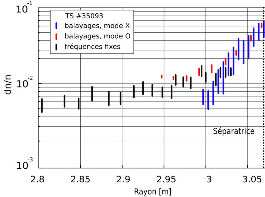
**Fig. 5.4** – Profils radiaux du niveau de fluctuations de densité mesurés sur le même choc (TS #35093) aux mêmes instants, par réflectométrie à balayage mode O et X, et par réflectométrie à fréquences fixes.
