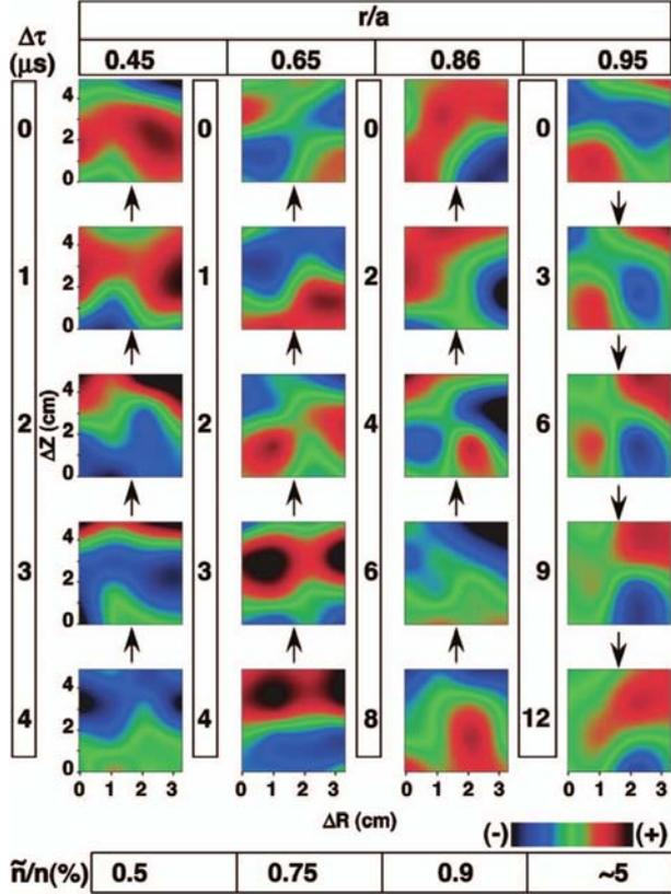
**Fig. B.4** – Imagerie de turbulence plasma pour quatre décharges différentes : chaque décharge correspond à une colonne, pour une position radiale moyenne différente. Sur chaque image sont reportées en couleurs les écarts au niveau de turbulence moyen, indiqué en bas. Les flèches indiquent la direction principale des écoulements turbulents, [McKee 06].
