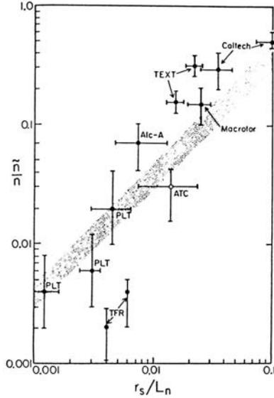
**Fig. 5.18** – Évolution des fluctuations de densité  $\delta n/n$  avec la longueur de gradient de densité locale  $L_{n_e}$ , normalisée au rayon de Larmor ionique local, calculé pour  $T_e = T_i$ , sur différents tokamaks [Liewer 85].
