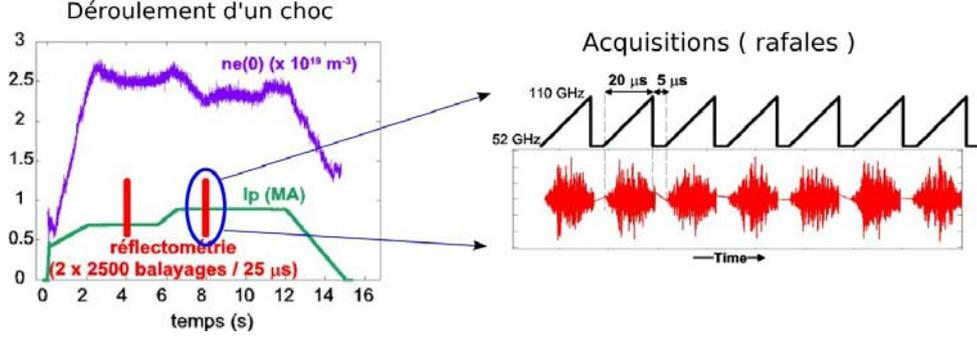
**Fig. 4.4** – Fonctionnement en mode d’acquisition *rafales* du réflectomètre lors d’un choc de Tore Supra. La densité électronique centrale et le courant plasma sont représentés. Les acquisitions sont divisées en deux groupes de 2500 rafales, permettant d’étudier la turbulence plasma pendant deux fenêtres de 62,5 ms
