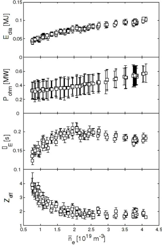
**Fig. 5.15** – De bas en haut :  $E_{dia}$ , énergie stockée dans le plasma, issue des mesures diamagnétiques ;  $P_{ohm}$ , puissance ohmique ;  $\tau_E$ , temps de confinement de l'énergie  $E_{dia}/P_{ohm}$  ;  $Z_{eff}$ , charge effective moyenne. Figure issue de [Kočan 08a].
