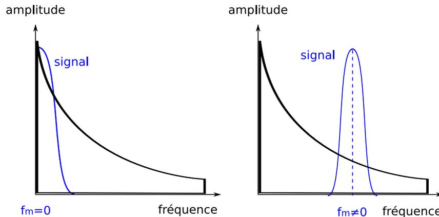
**Fig. 4.3** – Puissance spectrale du signal enregistré à la sortie du mélangeur sur une fréquence porteuse de 160 MHz. Illustration du rapport signal/bruit pour une détection homodyne (gauche) qui est de l'ordre de 20 dB et pour une détection hétérodyne (droite) de l'ordre 30 dB.
