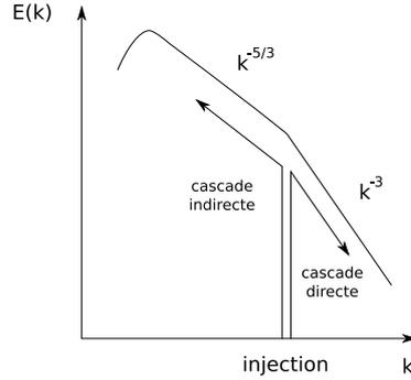
**Fig. 4.41** – Double cascade dans une turbulence 2-D forcée. L'échelle d'injection de l'énergie définit deux zones, où le spectre de l'énergie  $E(k)$  suit la similitude appropriée.
