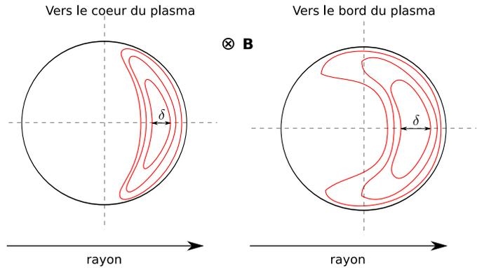
**Fig. 2.4** – Trajectoires *bananes* des particules piégées par les miroirs magnétiques. La différence entre les trajectoires pour les particules de cœur, par rapport aux particules localisées vers le bord du plasma, vient de la différence des rayons de Larmor.  $\delta$  est l'extension radiale de la trajectoire.
