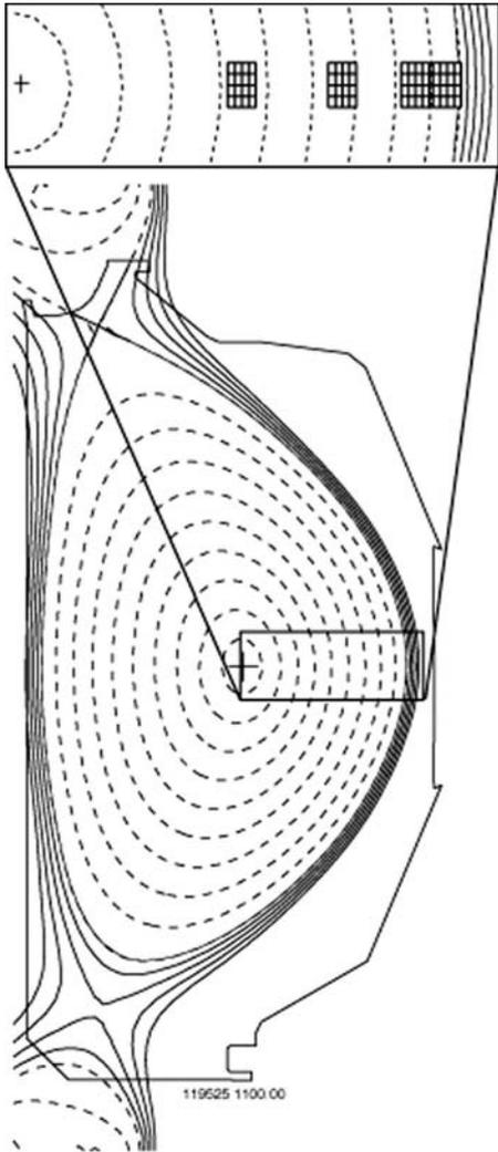
**Fig. B.2** – Reconstruction de l'équilibre magnétique par EFIT montrant la position des 32 voies spatiales de la BES sur DIII-D : un réseau radial de 14 voies, et deux réseaux poloïdaux de 8 voies chacune. Il est possible de modifier cette configuration entre deux décharges, permettant de mesurer les variations radiales sur tout le profil. [McKee 06]
