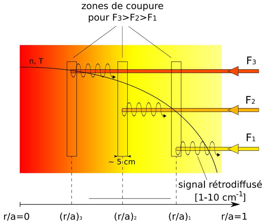
**Fig. 4.15** – Localisation spatiale des signaux rétrodiffusés dans la zone  $1 - 10 \text{ cm}^{-1}$ . En augmentant la fréquence de l'onde sonde, on déplace la localisation de la coupure et on sonde un plasma plus proche du cœur. L'analyse des fluctuations de phase  $\delta\phi$  de nombre d'onde  $1 - 10 \text{ cm}^{-1}$  permet de s'assurer que les fluctuations de densité  $\delta n$  à l'origine de leur rétrodiffusion sont localisées dans une zone d'environ  $5 \text{ cm}$  à la coupure.
