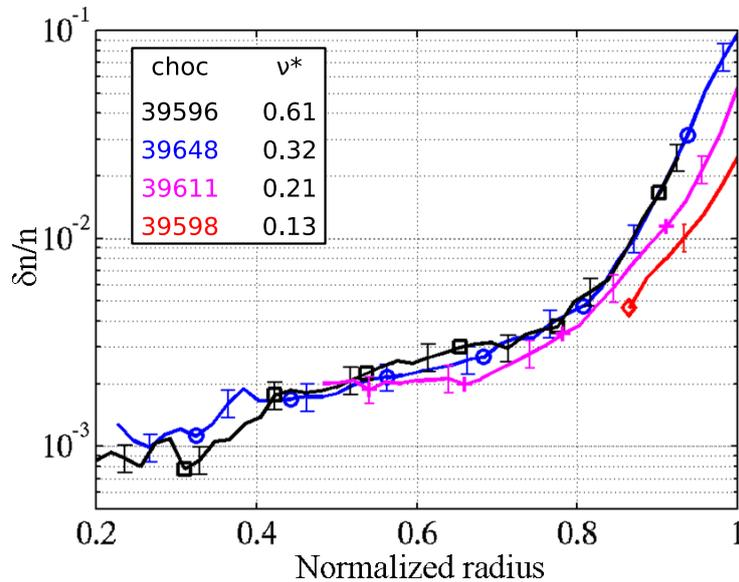
**Fig. 6.10** – Tracé en échelle semi-logarithmique des profils radiaux de  $\delta n/n$  mesurés par réflectométrie à balayage. diamants, rouges : #39598; plus, rose : #39611; cercles, bleus : #39648, carrés, noirs : #39596
