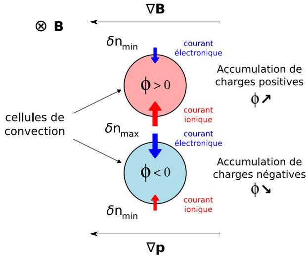
**Fig. 2.7** – Développement d’une instabilité de type *interchange*. La différence de potentiel électrique des deux cellules de convection est accrue par la combinaison des courants ioniques / électroniques dûs à la dérive électrique et à la courbure des lignes de champ.
