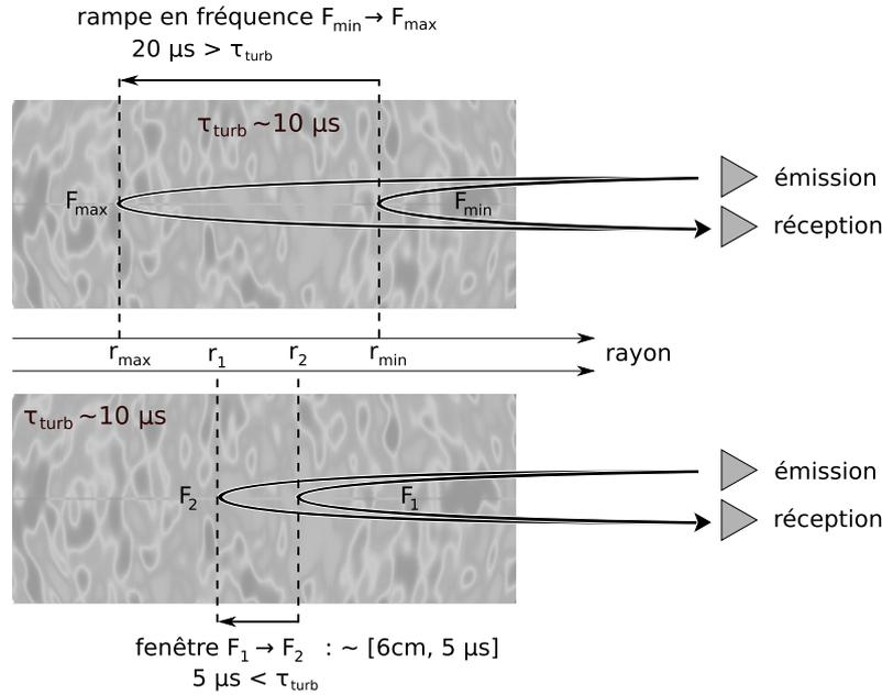
**Fig. 4.14** – La turbulence a un temps de cohérence estimé à  $10 \mu\text{s}$ . Un balayage complet de la source de fréquence (50-75 GHz ou 75-110 GHz), dure  $20 \mu\text{s}$  : pour une analyse globale, la turbulence n'est pas figée. L'analyse par fenêtres glissantes, de  $2\pi \text{ cm}$  implique une durée de balayage d'environ  $5 \mu\text{s}$  : la turbulence est *localement* figée.
