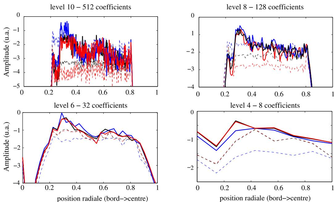
**Fig. 4.35** – TS #38314 - Logarithmes des coefficients d'ondelettes correspondant à la Fig. 4.34. Les 1<sup>re</sup> (hypothèse initiale, pointillés épais) et 5<sup>e</sup> itérations (résultat, traits épais) sont tracées, pour trois hypothèses initiales sur les puissances spectrales de la turbulence :  $k^0$  (bleu),  $k^{-2}$  (noir),  $k^{-6}$  (rouge).
