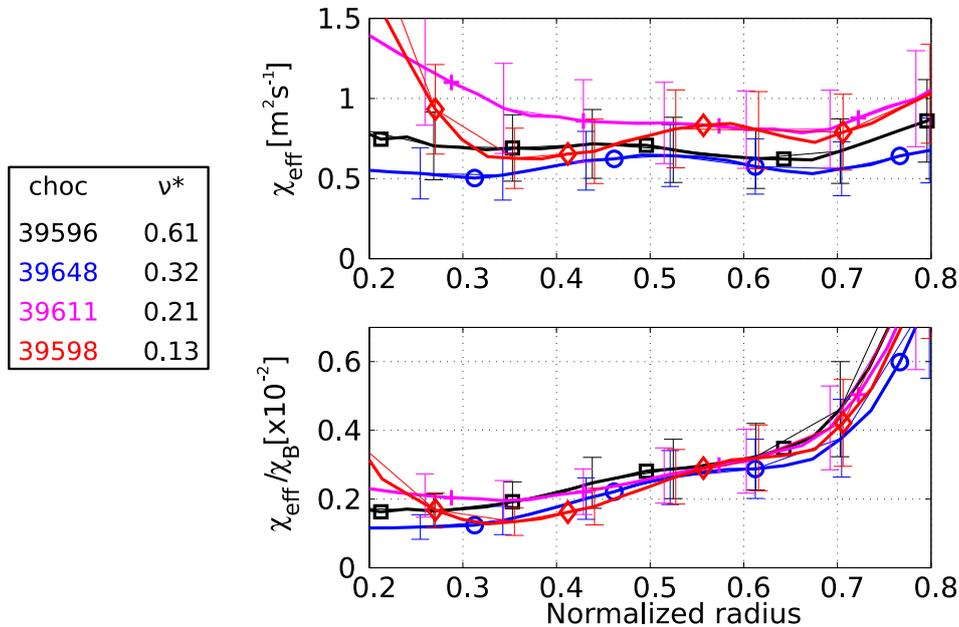
**Fig. 6.9** – Calcul du coefficient effectif de conductivité thermique  $\chi_{\text{eff}}$  par CRONOS : #39596 (noir), #39648 (bleu), #39611 (rose), #39598 (rouge). (a)  $\chi_{\text{eff}}$  en  $\text{m}^2/\text{s}$ ; (b)  $\chi_{\text{eff}}$  normalisé à la diffusivité thermique de Bohm.
