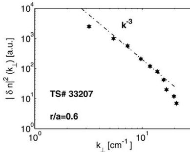
**Fig. 5.10** – Spectres en  $k_\theta$  mesurés par réflectométrie Doppler.
