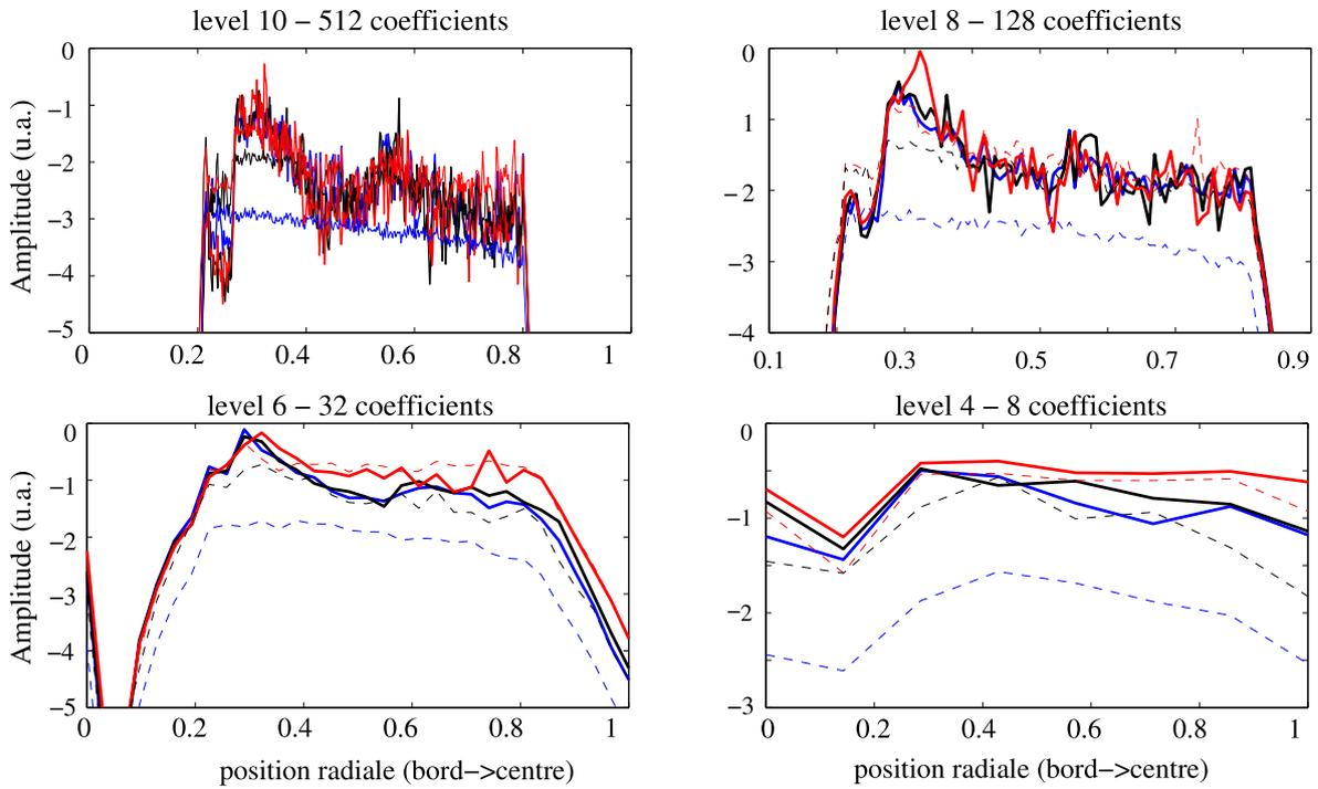
**Fig. 4.32** – TS #38314 - Logarithmes des coefficients d'ondelettes correspondant à la Fig. 4.31. La 1<sup>re</sup> itération (hypothèse initiale, pointillés épais) et la 5<sup>e</sup> itération (résultat, traits épais) sont tracées pour trois hypothèses initiales sur l'intensité des  $\delta n/n$  : faible (bleu), moyenne (noir), forte (rouge).
