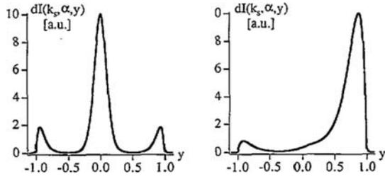
**Fig. B.10** – Localisation de l'énergie du signal diffusé pour différents nombre d'onde :  $k = 15 \text{ cm}^{-1}$ ,  $\alpha = 0^\circ$  à gauche,  $k = 6 \text{ cm}^{-1}$ ,  $\alpha = 5^\circ$  à droite.  $y$  correspond à la position radiale normalisée au petit rayon  $a$ . [Devynck 93]
