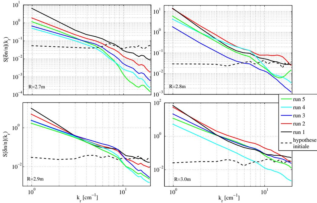
**Fig. 4.30** – TS #38314 - Puissances spectrales  $S_{\delta n}(k_r, r)$  des fluctuations de densité expérimentales entre 1 et 20  $\text{cm}^{-1}$  pour quatre positions radiales. Les 1<sup>re</sup> (noir), 2<sup>e</sup> (rouge), 3<sup>e</sup> (bleu), 4<sup>e</sup> (cyan) et 5<sup>e</sup> (vert) itérations sont représentées, ainsi que l'hypothèse de turbulence initiale (pointillés). Les spectres sont moyennés sur 1500 balayages.
