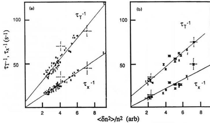
**Fig. 3.1** – Corrélation obtenue entre le temps de confinement de l'énergie et les mesures de fluctuations de densité sur TFR. La figure de gauche correspond à des décharges avec ajout de puissance ICRH, celle de droite à un chauffage par injection de neutres.  $\tau_T$  correspond au temps de confinement des électrons et  $\tau_X$  est identique à  $\tau_T$ , les pertes de dents de scies ayant été retirées. [Wootton 90]
