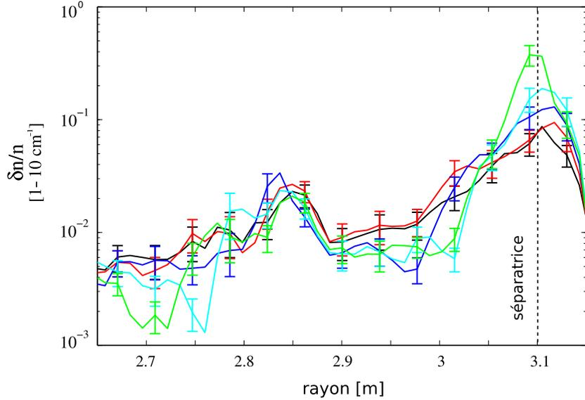
**Fig. 4.28** – TS #38314 - Estimation des profils moyens des fluctuations de densité expérimentales  $\delta n/n(r)$ , intégrés entre 1 et 10  $\text{cm}^{-1}$  pour 10 itérations successives. Axe magnétique à 2.4 m. Seuls les profils utilisés pour les 1<sup>re</sup> (noir), 3<sup>e</sup> (rouge), 5<sup>e</sup> (bleu), 7<sup>e</sup> (cyan) et 9<sup>e</sup> (vert) itérations sont représentées ; les traits épais sont des lissages et les barres d'erreurs sont les déviations standards.
