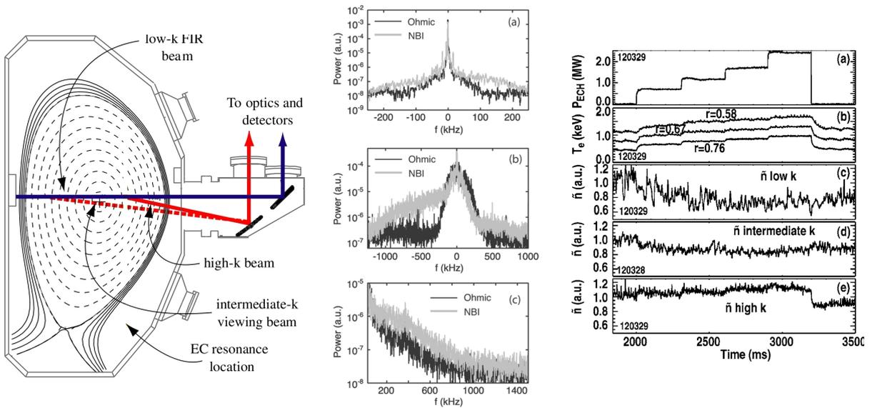
**Fig. B.8 – (gauche) :** Géométrie du diagnostic de diffusion installé sur DIII-D. La diffusion vers l'avant permet d'étudier les nombres d'ondes entre 0 et  $11 \text{ cm}^{-1}$ , alors que la diffusion vers l'arrière donne accès à la région 35 et  $40 \text{ cm}^{-1}$ . Les surfaces de flux sont tracées. [Rhodes 07b]
