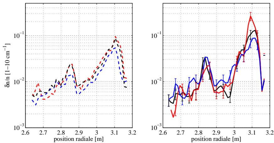
**Fig. 4.33** – TS #38314 - Profils moyens des fluctuations de densité expérimentales, intégrés entre 1 et  $10 \text{ cm}^{-1}$ , correspondant à Fig. 4.31. Trois hypothèses initiales sur l'intensité des  $\delta n/n$  sont testées : faible (bleu), moyenne (noir), forte (rouge). (gauche) : après une itération ; (droite) : après 5 itérations.
