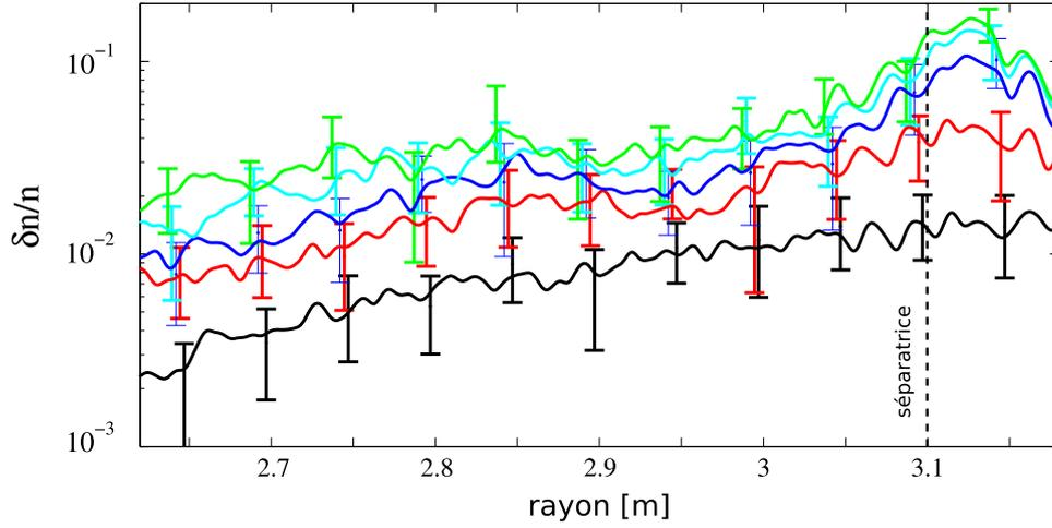
**Fig. 4.25** – TS #38314 - Profils moyens des fluctuations de densité simulées  $\delta n/n(r)_{sim}$  pour 10 itérations successives. Axe magnétique à 2.4 m. Seuls les profils utilisés pour les itérations 1 (noir), 3 (rouge), 5 (bleu), 7 (cyan) et 9 (vert) sont représentés ; les traits épais sont des lissages, et les barres d'erreurs sont les déviations standards.
