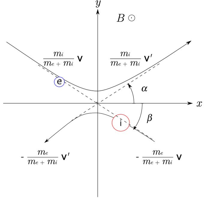
**Fig. 2.6** – Collision électron-ion dans le repère du centre de masse.  $\mathbf{v} = \mathbf{v}_e + \mathbf{v}_i$  et  $\mathbf{v}' = \mathbf{v}'_e + \mathbf{v}'_i$  sont les vitesses avant et après la collision.
