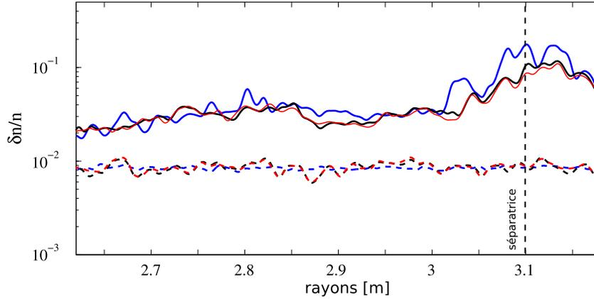
**Fig. 4.34** – TS #38314 - Estimation des profils radiaux de fluctuations de densité simulés injectés dans la 1<sup>re</sup> itération (hypothèse initiale, pointillés épais) et la 5<sup>e</sup> itération (résultat, traits épais), pour trois hypothèses initiales sur les puissances spectrales de la turbulence :  $k^0$  (bleu),  $k^{-2}$  (noir),  $k^{-6}$  (rouge).
