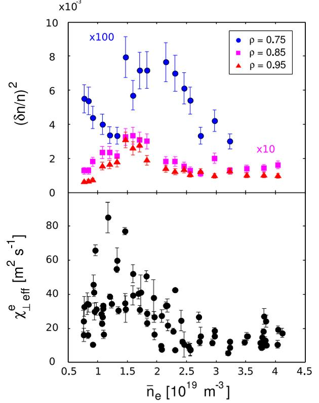
**Fig. 5.16** – Comparaison entre les mesures de  $(\delta n/n)^2$  par réflectométrie à balayage (haut) pour trois positions radiales différentes ( $r/a = 0.75, 0.85, 0.95$ ), et les valeurs estimées des coefficients de transport effectif de la chaleur  $\chi_e$  à partir des mesures des sondes RFA ( $r/a \approx 1$ ). Les valeurs de  $(\delta n/n)^2$  et  $\chi_e$  sont tracées en fonction de la densité centrale moyenne  $\bar{n}_e$ .
