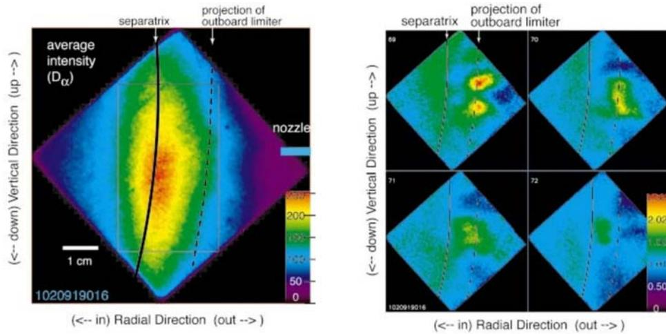
**Fig. B.6** – (gauche :) Image moyennée temporellement de la raie  $D_\alpha$  émise par le nuage de gaz injecté, sur un plan perpendiculaire au champ local. La variation poloïdale de l'image moyenne est due à la distribution du gaz sortant de l'injecteur.
