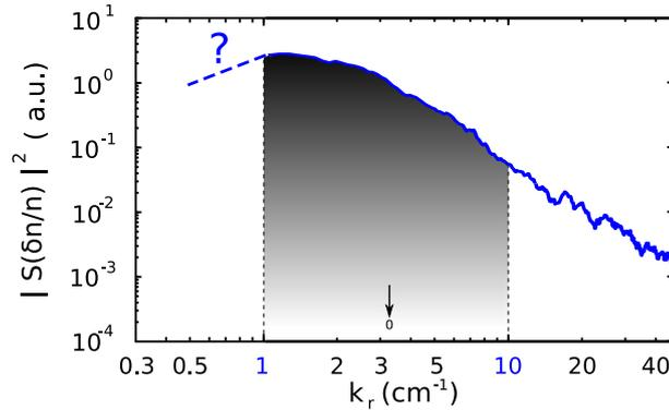
**Fig. 4.38** – Spectre en  $k_r$  des  $\delta n$  expérimentales, à  $r/a = 0.5$  (TS #39596). Le niveau de fluctuations  $\delta n(r/a = 0.5)$  est obtenu par intégration du spectre mesuré entre 1 et  $10 \text{ cm}^{-1}$ .
