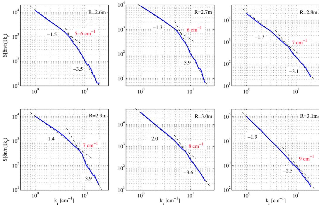
**Fig. 4.40** – TS #38314 - Spectres de puissance en  $k_r$  correspondant à Fig. 4.39 pour différentes positions radiales. L'axe magnétique se situe à 2.4 m et la séparatrice à 3.1 m. Représentation log-log.
