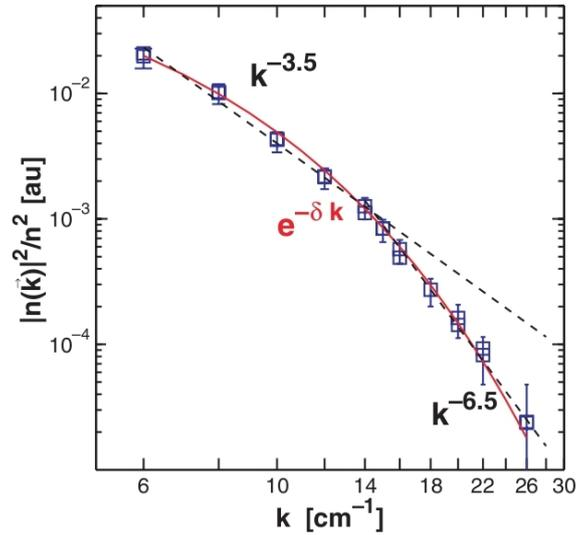
**Fig. B.12** – Spectre en  $k$  des densité de fluctuations  $|n(k)|^2$ . Les modélisations en lois puissance (pointillés) sont faites avant et après la transition, aux alentours de  $12 \text{ cm}^{-1}$ . La ligne pleine correspond à une modélisation en loi exponentielle  $e^{-\alpha k}$ , [Hennequin 04b]
