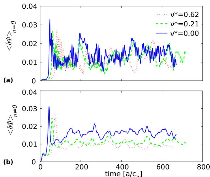
**Fig. 6.14** – (a) Evolution temporelle des valeurs RMS de l'intensité des flux zonaux, pour différents niveaux de collisionnalité, pour les conditions plasmas des chocs #39596 et #39611, à  $r/a = 0.5$ ; (b) Evolution temporelle des valeurs RMS de l'intensité des composantes à  $n \neq 0$  du potentiel électrostatique pour les mêmes devra être clarifiéconditions. Figure réalisée par A. Casati.
