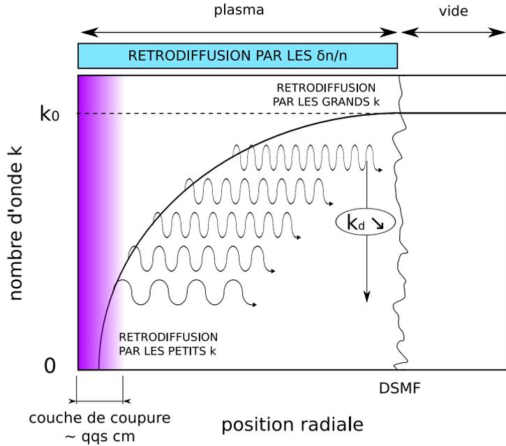
**Fig. 4.13** – Rétrodiffusion de Bragg dans un plasma fluctuant. Le module du vecteur d'onde local, proportionnel à l'indice de réfraction  $N$ , évolue de  $|k_0|$  lors de l'émission dans le vide, à 0 à la coupure. La décroissance est rapide.
