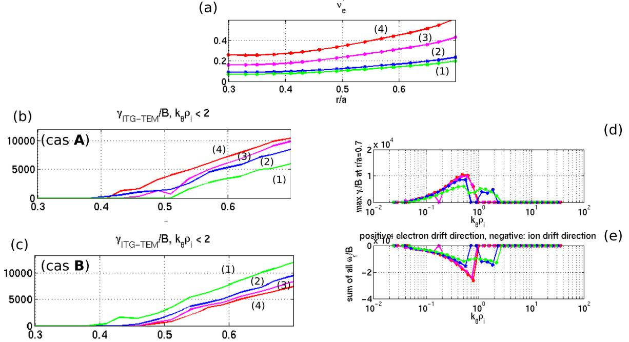
**Fig. 6.12** – Simulations KineZero réalisées par C. Bourdelle pour les chocs (1) #39598, (2) #39611, (3) #39648, (4) #39596. (a) Profils radiaux de  $\nu^*$ . (b) : (cas **A**) : paramètres expérimentaux réels ; (c) : (cas **D**) : seuls  $\nu^*$  varie ; (d) : (cas **A**) amplitude normalisée du mode dominant pour  $r/a=0.7$  (e) : (cas **A**) fréquences correspondantes.
