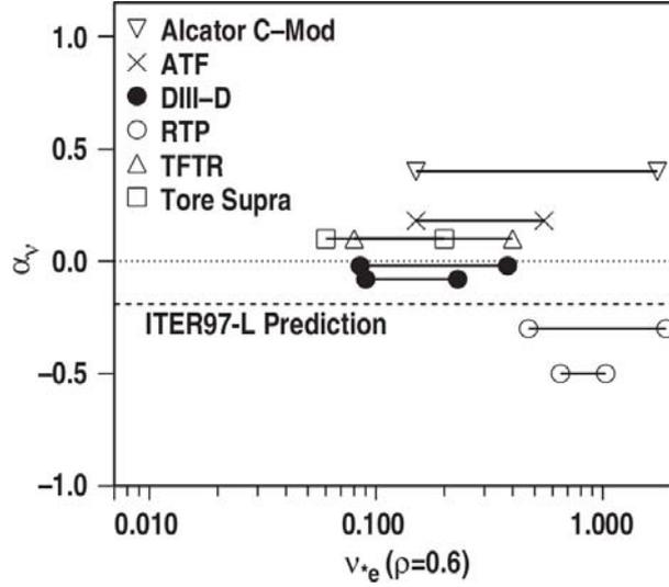
**Fig. 6.1** – Dépendance du temps de confinement de l'énergie  $B\tau_E$  avec  $\nu^*$  devra être clarifié (calculé à  $r/a = 0.6$ ) pour des plasmas en mode L. Pour chaque expérience menée sur une machine spécifique, l'extension du domaine de collisionnalité étudié est reportée, ainsi que l'exposant  $\alpha_\nu$  de la relation  $B\tau_E \propto \nu^{*\alpha_\nu}$ . La prédiction de la loi de confinement globale ITER97-L est représentée en tirets. Figure issue de [Luce 08].
