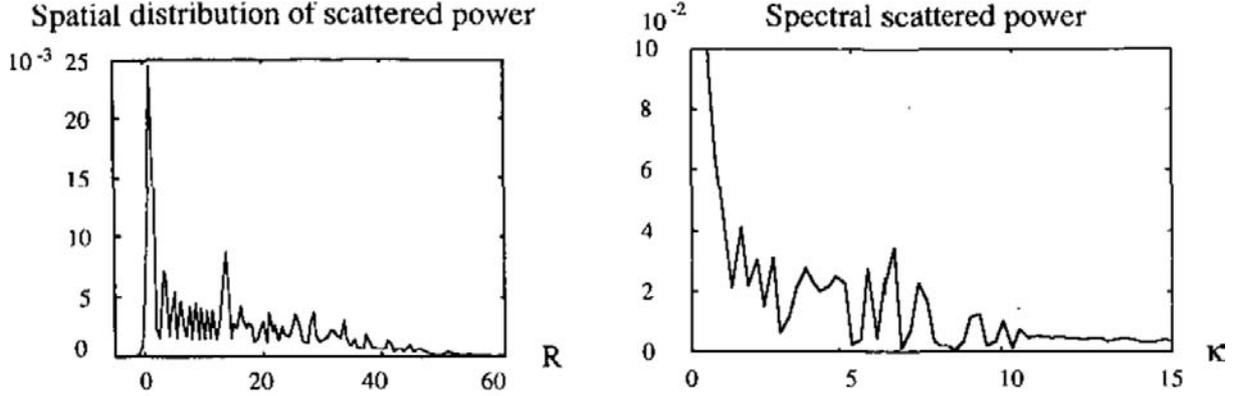
**Fig. 4.10** – Distributions spatiale (gauche) et spectrale (droite) du signal diffusé, pour un spectre de turbulence uniforme.  $\kappa$  et  $R$  sont les nombres d'ondes incidents et les positions radiales normalisées. La coupure est à  $R = 0$ . [Zou 91]
