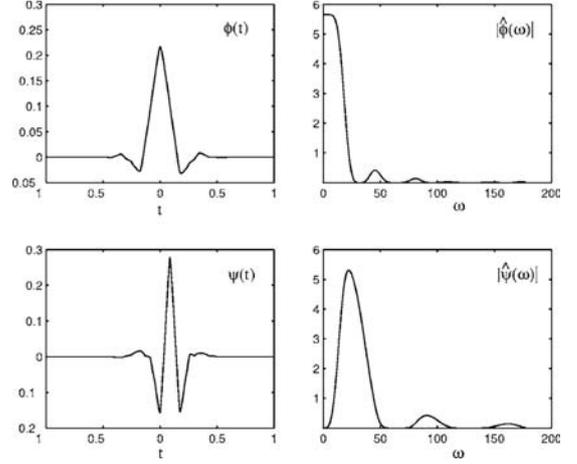
**Fig. 4.23** – Ondelette utilisée : *coiflet 12*. La fonction d'échelle est tracée en haut, ainsi que le module de sa transformée de Fourier (haut, droite). L'ondelette est tracée en bas, ainsi que le module de sa transformée de Fourier (bas, droite). Graphique issu de [Farge 06]
