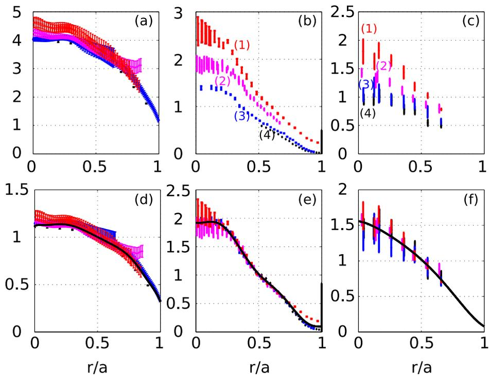
**Fig. 6.7** – Profils expérimentaux (a,b,c) et normalisés à leur valeur à  $r/a = 0.5$  (d,e,f) pour les chocs (1) #39598, (2) #39611, (3) #39648, (4) #39596. (a) Densité électronique,  $\times 10^{19} \text{ m}^{-3}$ ; (b) Température électronique, keV; (c) Température ionique, keV; (d) Densité électronique normalisée à  $r/a = 0.5$ ; (e) Température électronique normalisée à  $r/a = 0.5$ ; (f) Température ionique normalisée à  $r/a = 0.5$ ; (d),(e),(f) : les profils moyens sont en noir.
