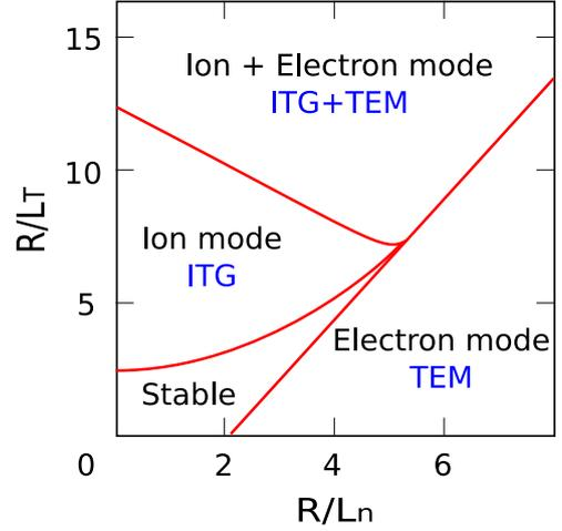
**Fig. 2.10** – Diagramme de stabilité des modes ITG/TEM, pour  $T_i = T_e$ .  $R$  est le grand rayon du tokamak,  $L_T = T/\nabla T$  et  $L_n = n/\nabla n$  sont les longueurs de gradient de densité et de température. Issue de [Garbet 01].
