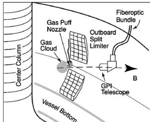
**Fig. B.5** – Schéma de principe du diagnostic GPI sur Alcator C-Mod. Le gaz de  $^2\text{H}$  pénètre dans la chambre par un bec d'injection, et son émission  $D_\alpha$  est réceptionnée le long d'un ligne magnétique par le télescope GPI, sur le mur externe à 50 cm. L'image 2D de l'émission lumineuse est transférée par fibre optique au système d'acquisition située sur le haut de la machine, [Zweben 02]
