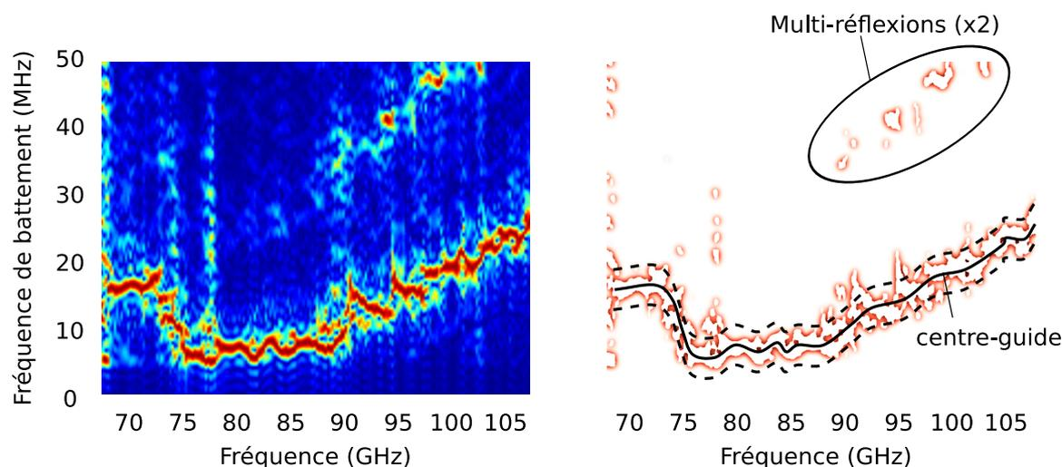
**Fig. 4.16** – Signal d'un écho plasma typique. A chaque fréquence de sondage correspond une fréquence de battement. (gauche) : spectres fréquentiels normalisés, calculés par FFT glissantes pour chaque fréquence de sondage. (droite) : mise en évidence du centre-guide, et du filtrage d'une largeur de quelques MHz. Des multi-réflexions ( $\times 2$ ) sont visibles.
