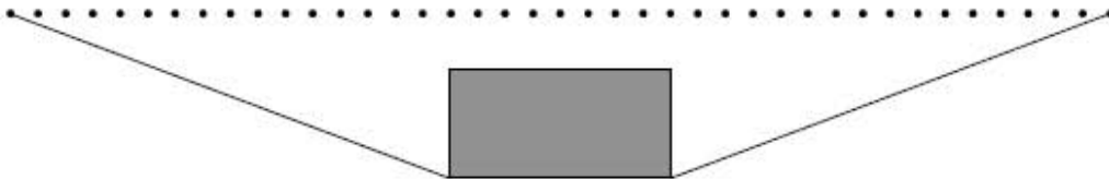
Figure. I.6 – Corde élastique sous chargement discontinu
