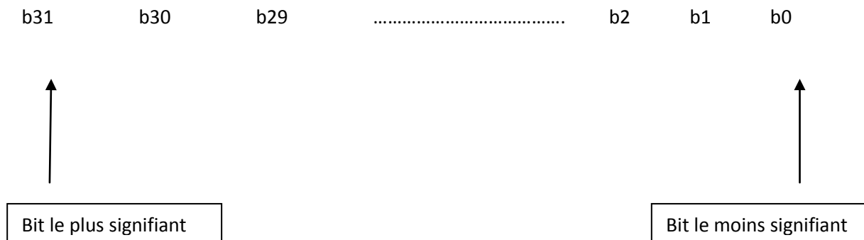
Figure II.5 : Chaque gène (chaque paramètre du dispositif) est codé par un entier long (32 bits).
