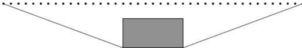
Figure. I.6 – Corde élastique sous chargement discontinu
