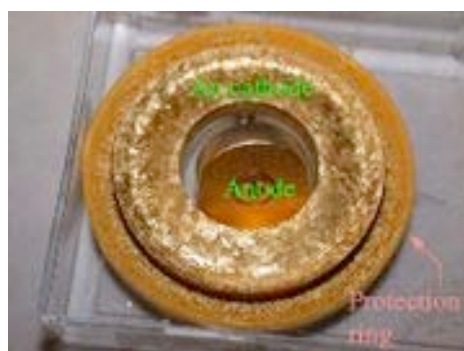
Figure 2.1 : Une cible de pulvérisation avec une géométrie typique en anneau, ici de l'or, montrant la cathode constituée du matériau à déposer, l'anode contre-électrode et un anneau extérieur pour éviter la pulvérisation du foyer qui maintient la cible.
