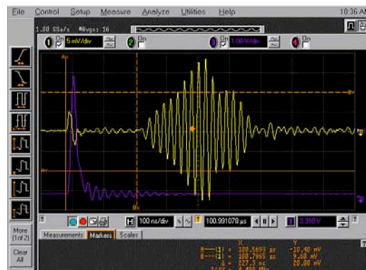
Figure 1.6 : Réponse impulsionnelle d'une ligne à deux transducteurs et de fréquence centrale de 43MHz
