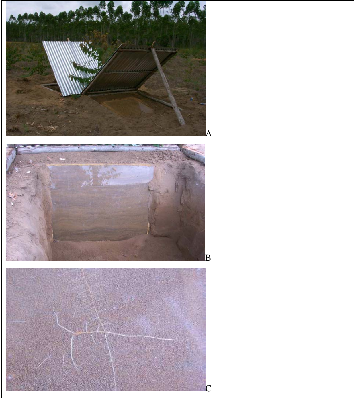
Figure IV-3 : Vue d'ensemble des deux types de rhizotrons (ici dans un jeune peuplement autre que celui utilisé dans cette étude, A), un rhizotron vertical après installation (B) et racines en croissance dans un rhizotron horizontal (C).
