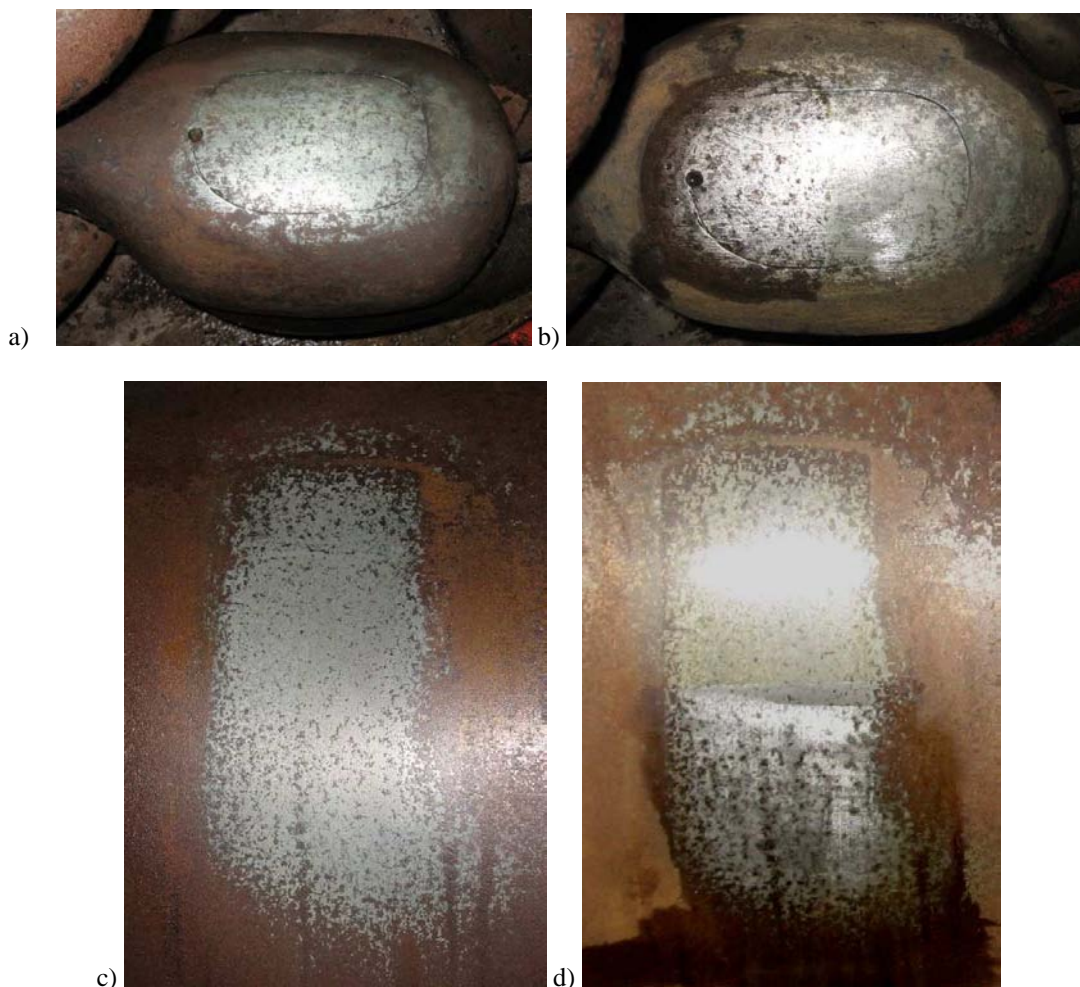
Figure V.15 : a) Chaîne d'ancre après préparation de la zone, et b) après traitement (partie gauche) c) Torpille après préparation de la zone, et d) après traitement (partie du bas)
