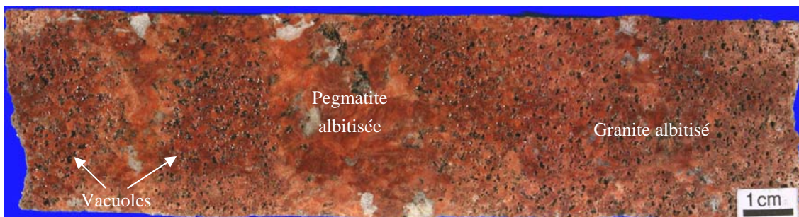
Figure IV - 3. Echantillon ESP-07-03 : exemple d'échantillon présentant des vacuoles.
