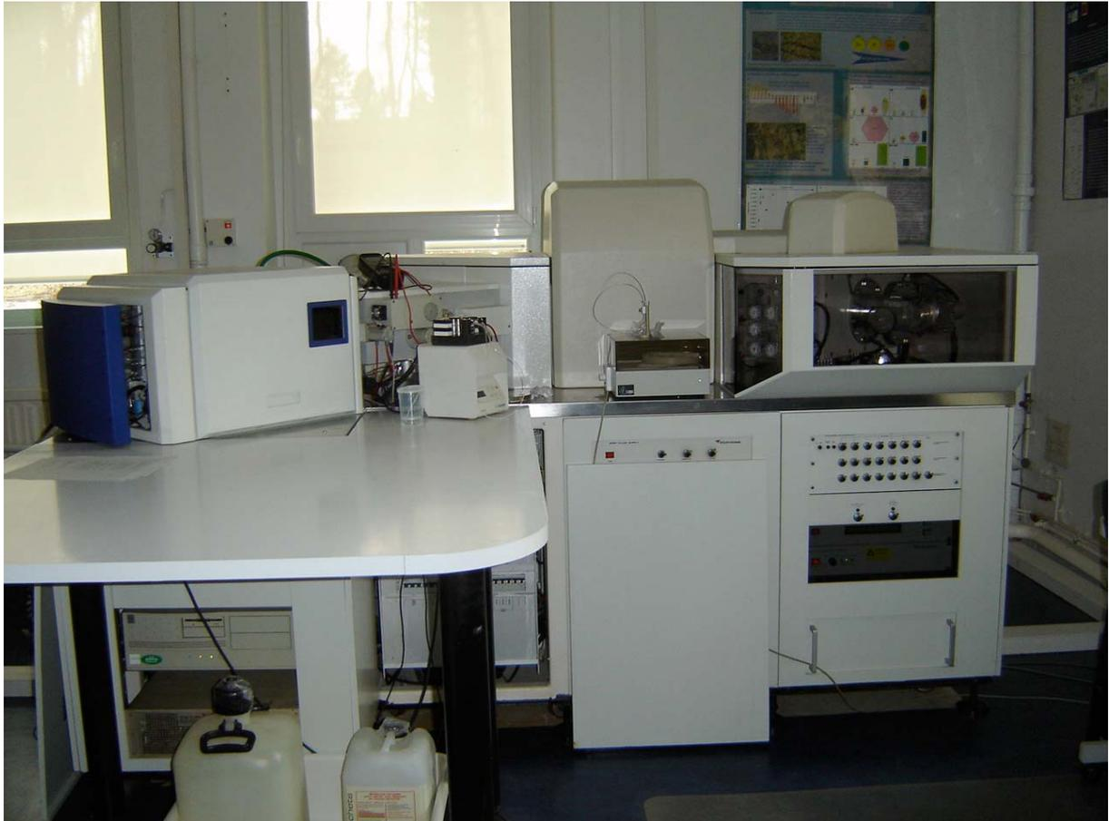
Le spectromètre de masse Isoprobe du CRPG
