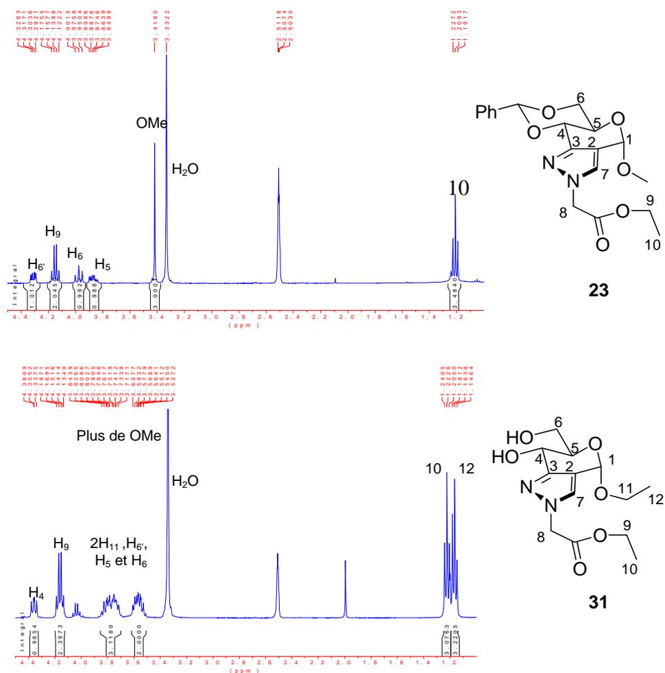
Figure 28. Spectres RMN<sup>1</sup>H dans le DMSO des composés **23** et **31**
