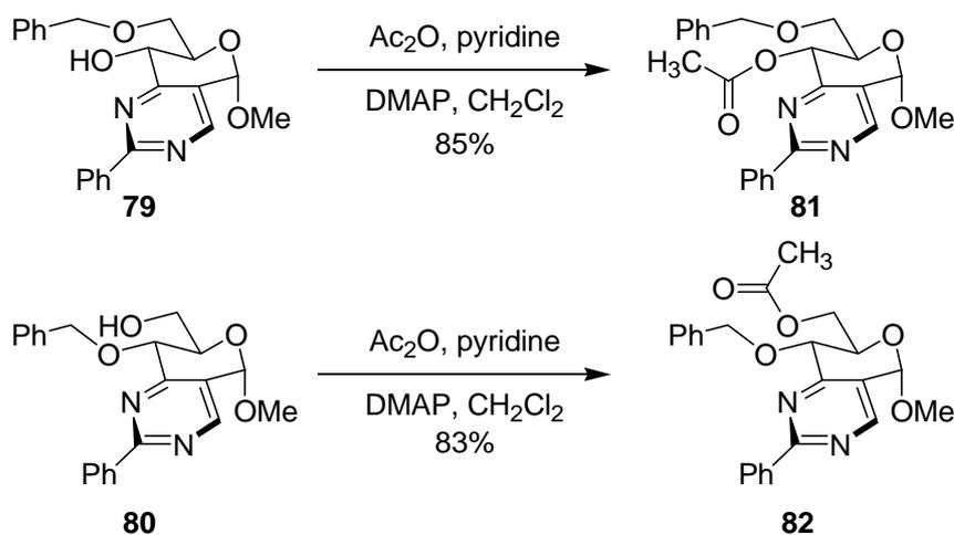
La variation des déplacements chimiques du proton H<sub>4</sub> pour **81** et des protons H<sub>6</sub> pour **82** consécutive à la formation d'une fonction ester a permis de confirmer la régiosélectivité de la réaction et la structure des produits.
