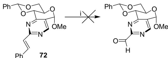
Schéma 92. i) O<sub>3</sub>, CH<sub>2</sub>Cl<sub>2</sub>, -78°C puis Me<sub>2</sub>S
