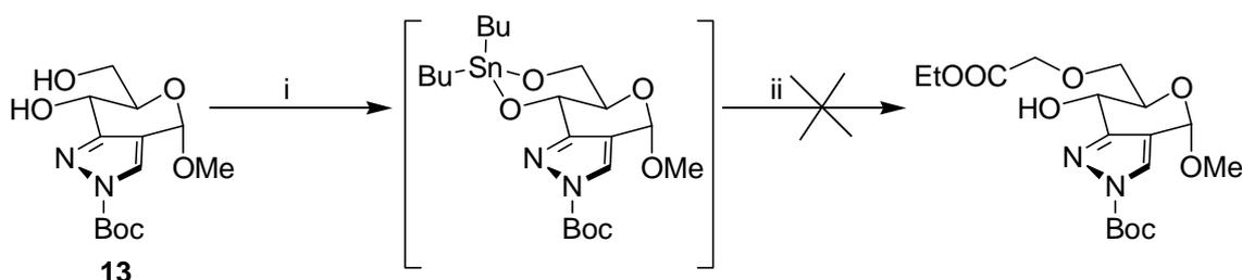
Schéma 39. i)  $\text{Bu}_2\text{SnO}$ /toluène; ii)  $\text{BrCH}_2\text{COOEt}$ /TBAI/toluène
