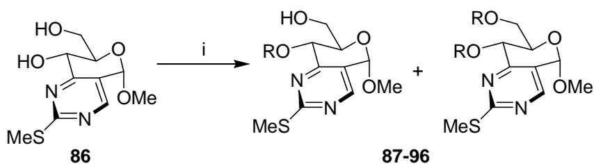
**Schéma 103.** i) Méthode A: NaH, RX, DMF ou THF, Méthode B: NaOH 30%, Bu<sub>4</sub>NHSO<sub>4</sub>, RX, toluène
