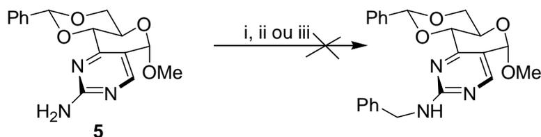
**Schéma 72.** i) PhCHO, NaBH<sub>4</sub>, CH<sub>2</sub>Cl<sub>2</sub> ii) PhCHO, Ti(OPr<sub>3</sub>)Cl, NaBH<sub>4</sub>, CH<sub>2</sub>Cl<sub>2</sub> iii) PhCHO, Ti(OPr<sub>3</sub>)Cl, CH<sub>2</sub>Cl<sub>2</sub>, MeOH, Tamis moléculaire
