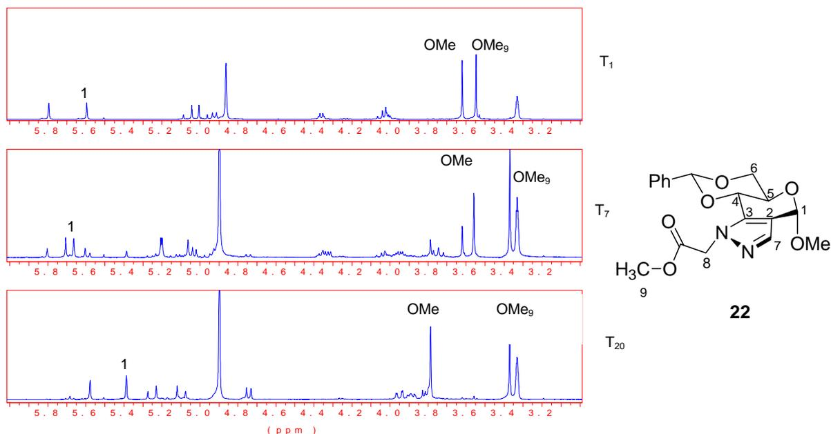
Figure 29. Méthanolyse du composé **22** suivie par RMN  $^1\text{H}$
