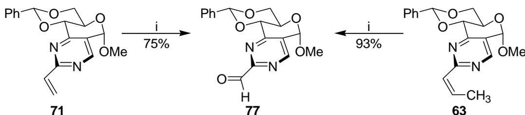
Schéma 93. i) O<sub>3</sub>, CH<sub>2</sub>Cl<sub>2</sub>, -78°C puis Me<sub>2</sub>S
