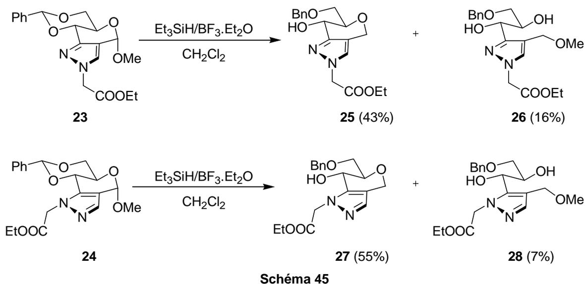
L'obtention de ces produits désoxygénés en position 1 (**25 et 27**) révèle la labilité du groupe OMe en position anomérique et s'expliquerait par le mécanisme suivant :
