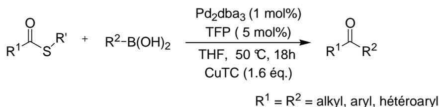
**Schéma 78.** Couplage de Suzuki sur un thioester
