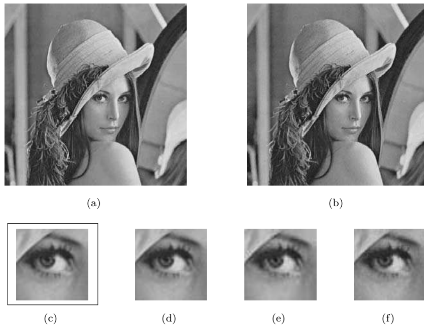
FIG. 5.7: Première rangée : visualisation de l'image « Lenna » reconstruite après compression par (1) JPEG avec facteur de qualité Q=30 (0.47bpp ; PSNR = 34.17dB) et (b) ICES à 3.75bpp (PSNR = 33.37dB).
