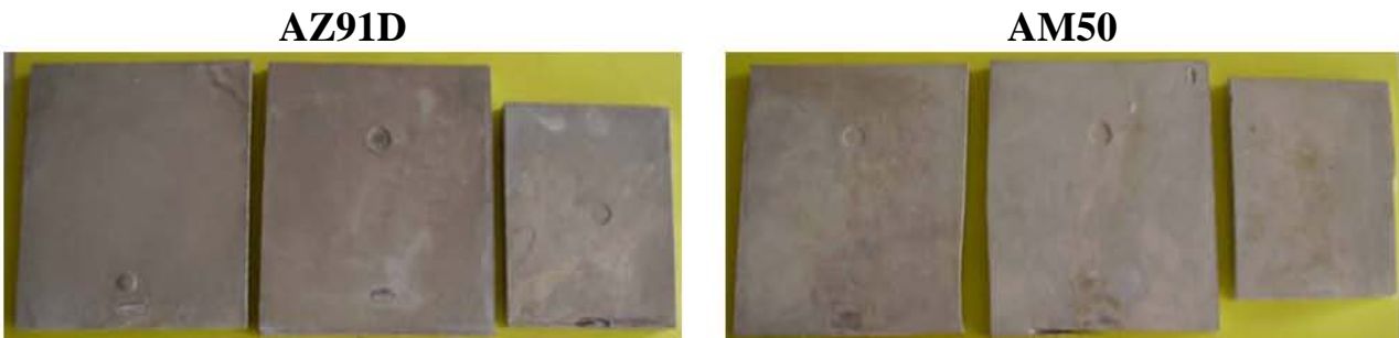
Figure IV.14 : aspect macroscopique des alliages AM50 et AZ91D traités 15 min dans le bain contenant du Ce(III).
