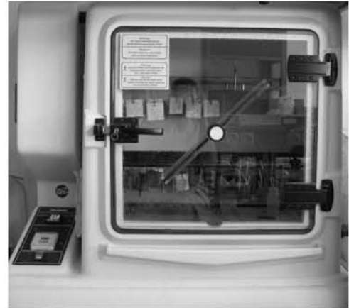
Figure II.4 : photographie de l'enceinte climatique, modèle KBEA 300 de Liebisch
