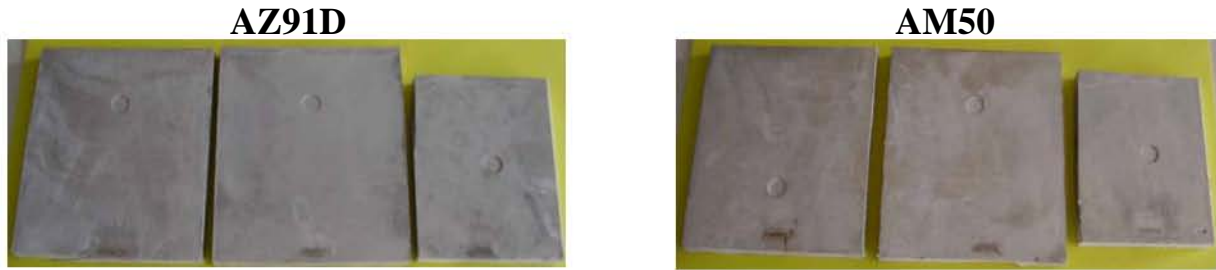
Figure IV.20 : aspect macroscopique des alliages AM50 et AZ91D traités 30 min dans le bain contenant des stannates.
