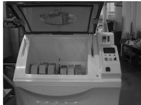
Figure II.5 : photographie de l'enceinte de brouillard salin, modèle LABOMAT S450.
