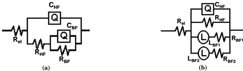
Figure III.19 : circuits électroniques équivalents utilisés pour modéliser les données d'impédance, (a) échantillons polis, (b) échantillons non polis.
