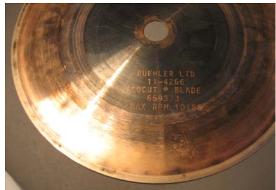
Figure 14 : disque diamanté Buehler®
