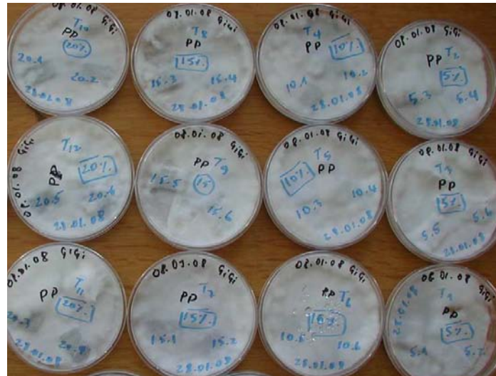
Figure 2. Aspect des éprouvettes de pin après 12 semaines d'incubation en présence de Poria placenta
