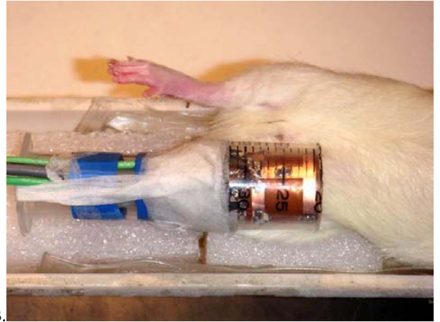
Figure 14. A. antenne radiofréquence possédant 2 éléments réceptifs en réseau permettant un accroissement du rapport S/B, développée par l'UMR CNRS 5220 de Lyon pour l'analyse in vivo à 7 Teslas chez le petit animal. B. Mise en place de l'antenne autour de l'articulation à étudier, en l'occurrence le genou de rat.
