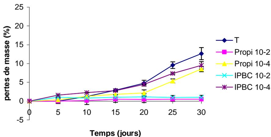
Figure 47 : Evolution des pertes de masses des éprouvettes de hêtre traité ou pas durant la dégradation par *T. versicolor*.
