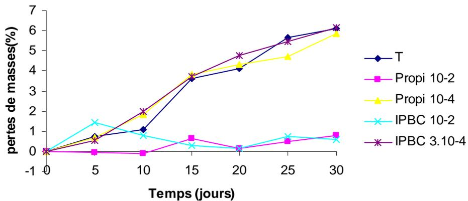
Figure 74 : Evolution des pertes de masses des éprouvettes de hêtre traité ou pas durant la dégradation par *Antrodia sp*
