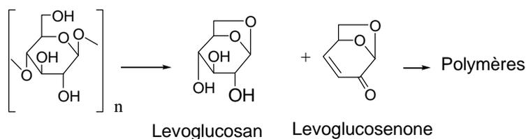
Figure 108 : Dépolymérisation de la cellulose et formation du levoglucosane
