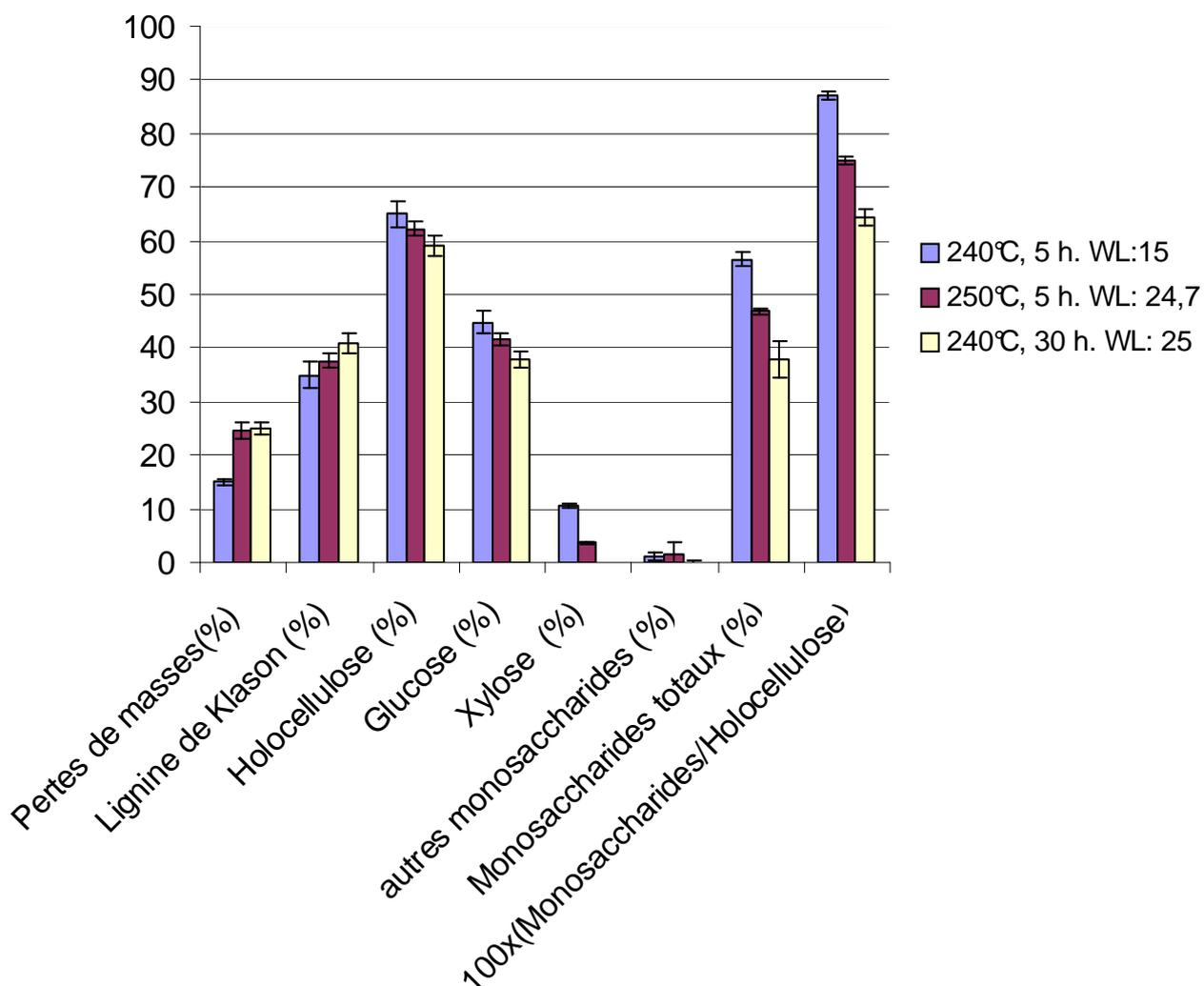
Figure 103 : Comparaison de la composition chimique du bois de hêtre traité à 240 ou 250°C durant une même durée de 5 heures ou pour une même perte de masse de 25%
