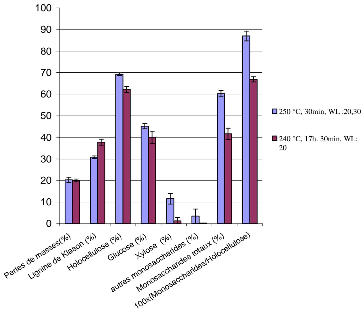
Figure 104 : Comparaison de la composition chimique du bois de hêtre traité à 240 ou 250°C pour une même perte de masse de 20 %
