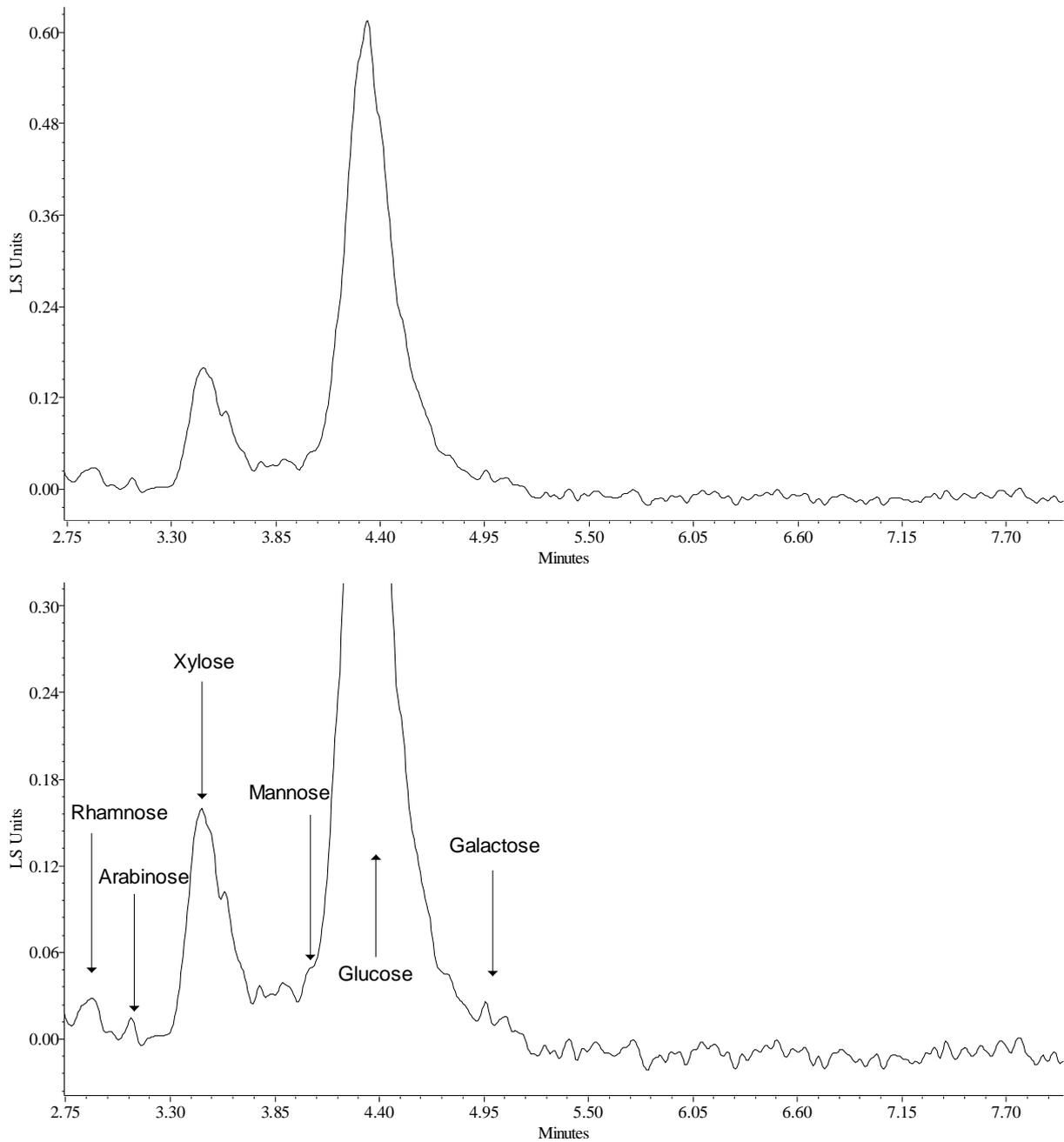
Figure 98 : Chromatogramme montrant la séparation des différents monosaccharides après hydrolyse d'un échantillon de hêtre. Discovery LC-NH<sub>2</sub> (250 mm x 4.6 mm i.d.), 30°C, acétonitrile / eau / méthanol (78/20/2) v/v, 1.5 mL.min<sup>-1</sup>
