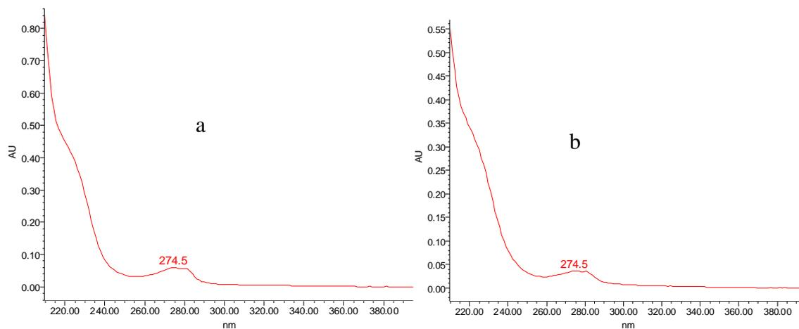
Figure 68 : spectre UV à 280nm du pic à 21,86 minutes (a) et 22,2 minutes (b)
