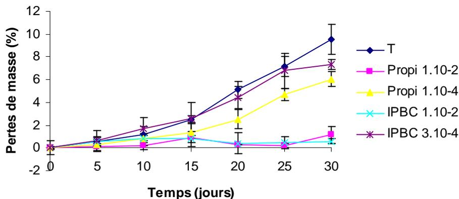
Figure 86 : Evolution des pertes de masse des éprouvettes de Pin traité ou non durant la dégradation par *Poria placenta*
