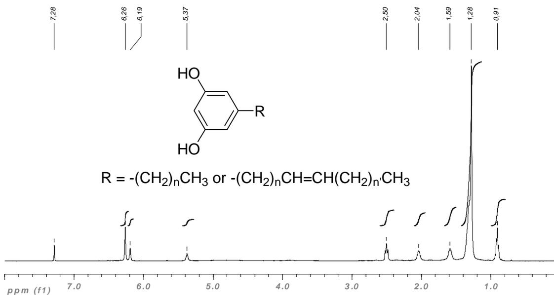
Figure 66 : Spectre RMN du proton des extraits au dichlorométhane du bois de *Grevillea robusta* (n-alkyl et n-alcenyl résorcinols (Mburu 2007))
