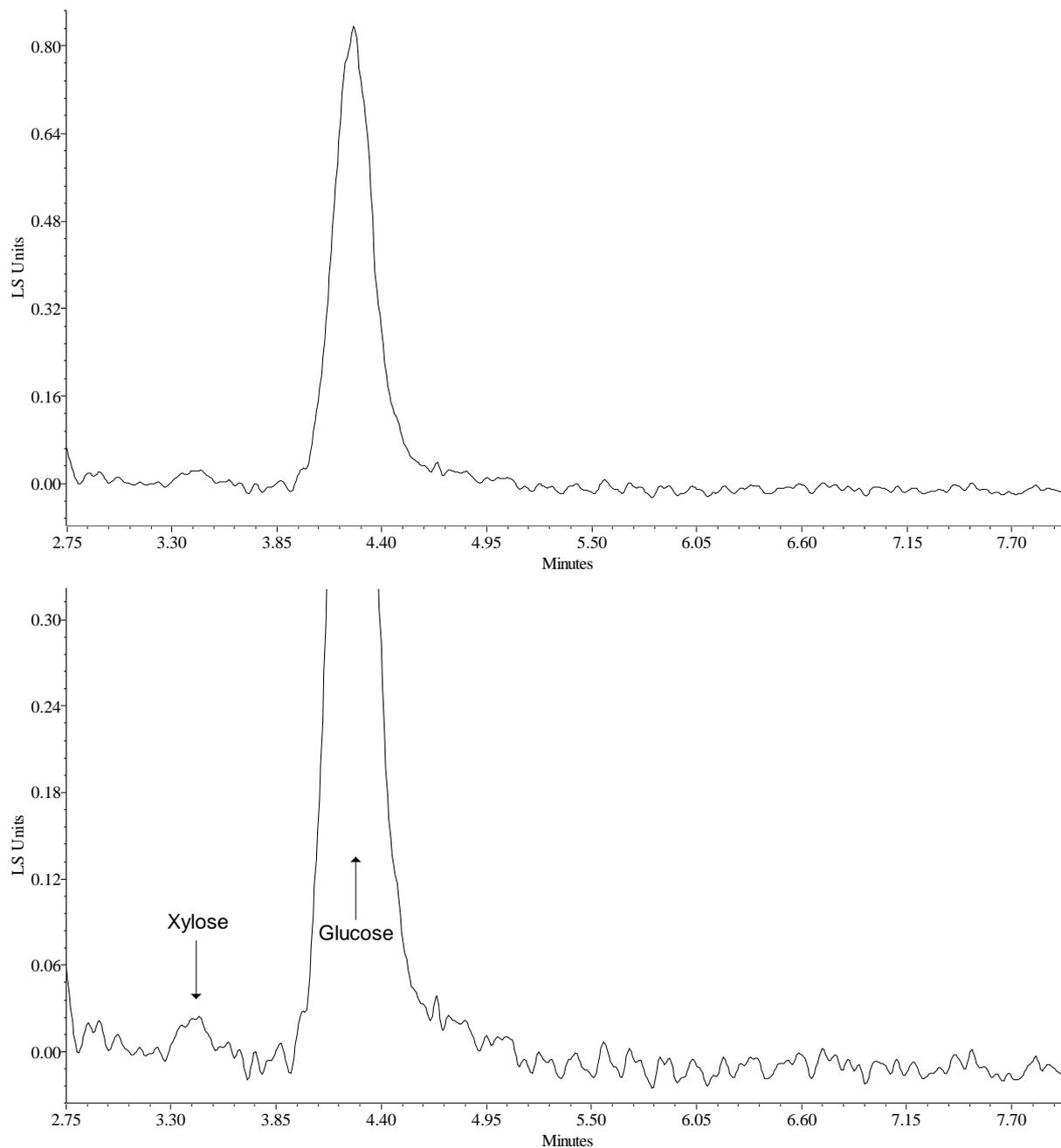
Figure 99 : Chromatogramme montrant la séparation des différents monosaccharides après hydrolyse d'un échantillon de hêtre traité à 240°C pendant 8 heures. Discovery LC-NH<sub>2</sub> (250 mm x 4.6 mm i.d.), 30°C, acétonitrile / eau / méthanol (78/20/2) v/v, 1.5 mL.min<sup>-1</sup>
