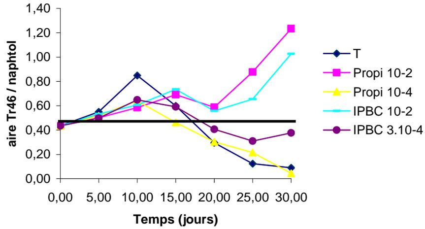
Figure 64 : Evolution du rapport: aire Tr 46 / aire naphthol) lors de la dégradation du bois de hêtre par *C. puteana*
