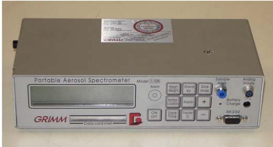
*Figure 26 : compteur optique type GRIMM 1.108*
