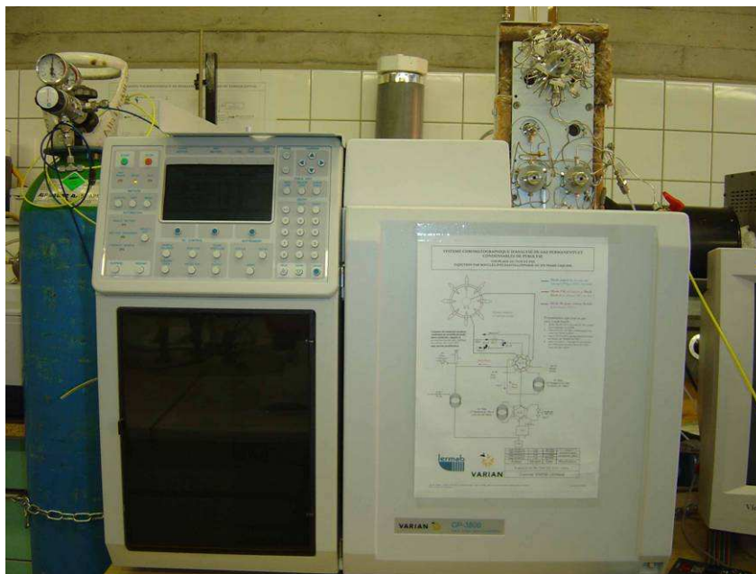
Figure 41: Vue d'ensemble du système d'analyse chromatographique GC – TCD (CP-3800 ; VARIAN)
