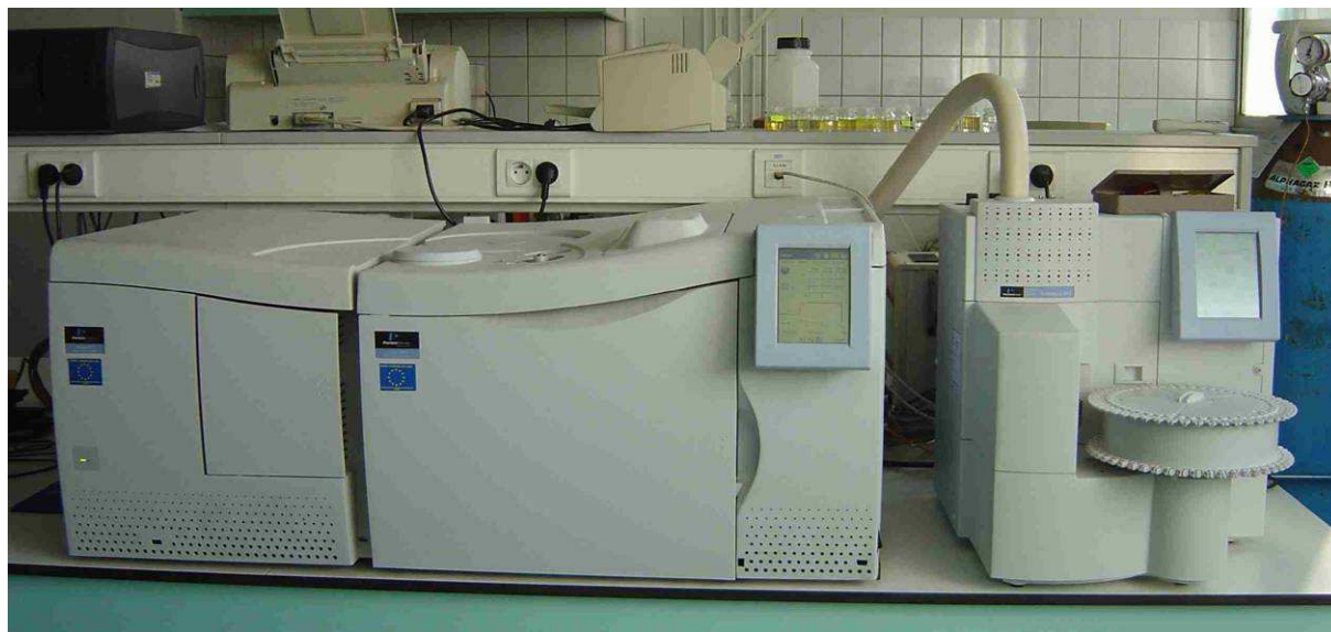
Figure 45: Vue d'ensemble du thermodésorbeur (TurboMatrix ATD ; PERKIN ELMER) et du système d'analyse chromatographique GC – MS (Clarus 500 ; PERKIN ELMER)
