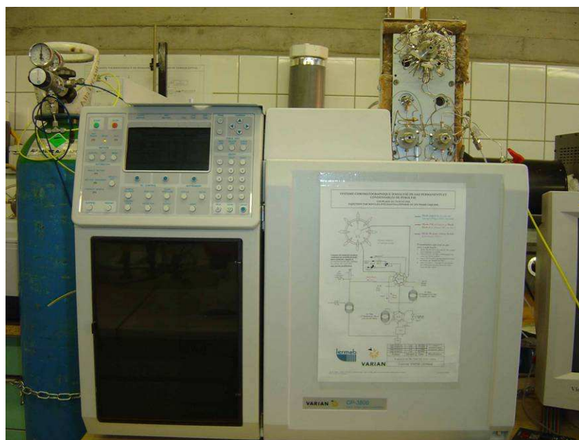
Figure 41: Vue d'ensemble du système d'analyse chromatographique GC – TCD (CP-3800 ; VARIAN)
