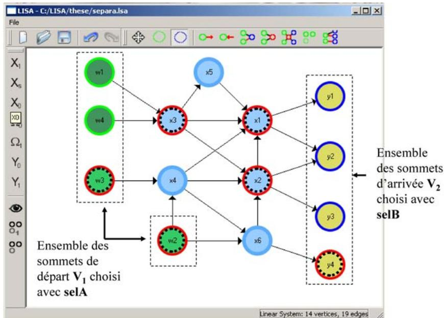
FIG. 4.10 – Calcul de séparateurs d’entrée et de sortie
