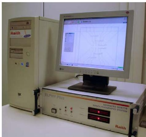
Fig. 2.13. Système de pilotage de lithographie Raith Elphy Plus.
