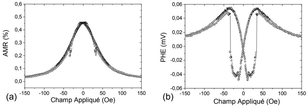
obtenues simultanément sur le même dispositif dans la direction difficile. D'un côté, la caractéristique d'AMR présentée dans la Fig. 3.47a est semblable à celle mesurées précédemment. D'un autre côté, à bas champs, la caractéristique d'effet Hall planaire est bien linéaire et impaire comme attendu et donc propice à l'utilisation en capteur de champ (Fig. 3.47b). En revanche à haut champs, on n'observe pas la réponse impaire attendue (présentée dans la Fig. 3.44b).
