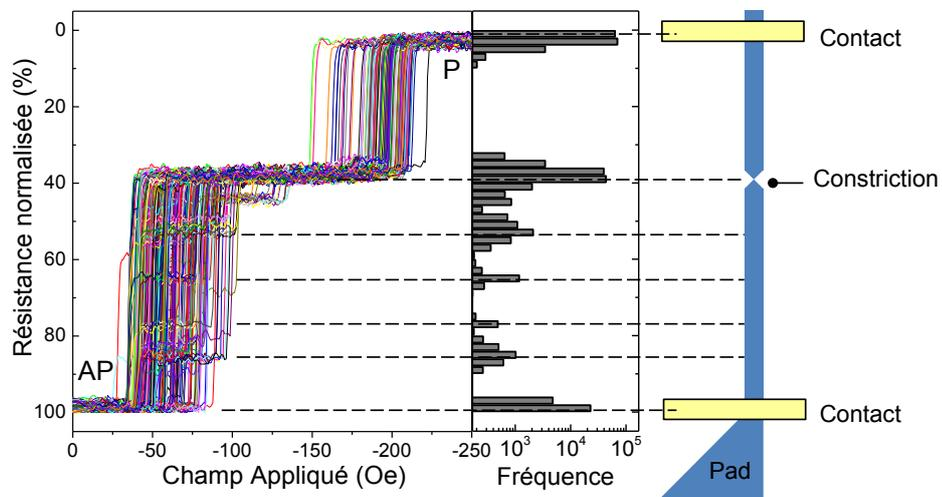
au dispositif *A*, plusieurs centaines de cycles de magnétorésistance ont été effectués sur ce dispositif. La Fig. 4.23 montre les mesures effectuées, ainsi que l'histogramme de résistance correspondant, pour une propagation AP  $\rightarrow$  P de la paroi. Tout d'abord, on y trouve que, contrairement au cas du dispositif *A*, la paroi de domaines est piégée par la constriction lors de chaque cycle (i.e. blocage = 100 %). Toutefois, on peut remarquer la présence de plusieurs
