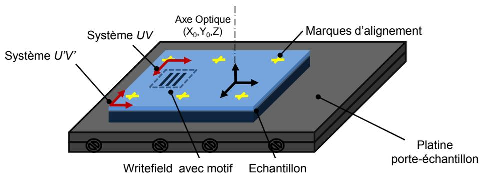
Des telles marques permettront, aussi, la définition d'un système UV plus précis et plus reproductible par rapport à un système appuyé sur les coins de l'échantillon (Fig. 2.33). En plus, si plusieurs niveaux de lithographie sont utilisés dans l'élaboration d'un échantillon, la présence de marques sert à l'alignement des différentes étapes.
