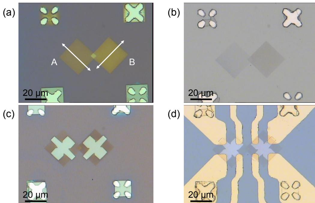
lithographie électronique dans une bicouche de résine. Les flèches indiquent la direction des lignes pour chaque réseau A et B. b) Surface du substrat modulée localement par gravure des réseaux de lignes définis en Al. c) Zones actives du capteur, réalisées par lithographie électronique et lift-off d'une couche de permalloy. d) Electrodes de mesure faites par lithographie UV et lift-off d'une couche de Ti/Au.
