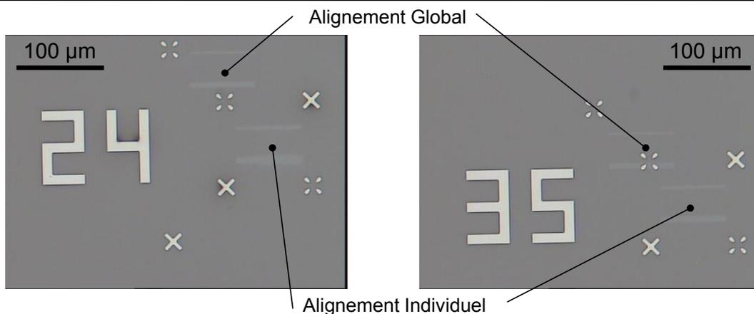
Bien que l'utilisation de l'alignement individuel impose, d'un part que la taille du writefield soit égale à 100  $\mu\text{m}$ , 200  $\mu\text{m}$  ou 500  $\mu\text{m}$ , et d'autre part que une seule structure peut être réalisée dans chaque cellule, le gain au niveau de précision du positionnement est considérable.
