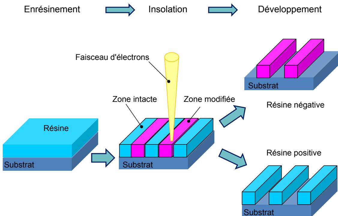
*lithographie électronique). Un faisceau d'électrons finement localisé est utilisé pour écrire directement des motifs dans une fine couche de résine pré-déposée sur le substrat.*
