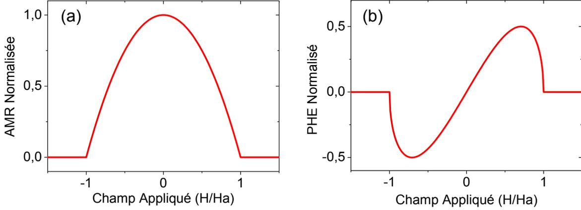
b) Le signal obtenu est décalé de 45° par rapport à la mesure longitudinale. Ainsi, la sensibilité est maximale lorsque  $H=0$ .
