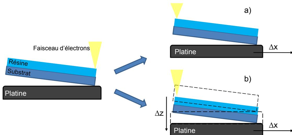
La méthode a) a été mise en place dans notre cas. Avant d'aborder le procédé de correction du réglage focal dit *autofocus*, nous allons nous intéresser à l'utilité et à la réalisation des marques d'alignement sur le substrat préalable à l'étape de lithographie électronique.
