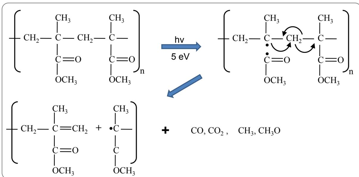
Si le PMMA est fortement surexposé, ses portions non volatiles vont polymériser en formant un matériau robuste et insoluble. Ce matériau aura une épaisseur plus faible que la couche initiale en raison de la perte des portions volatiles des molécules [3].
