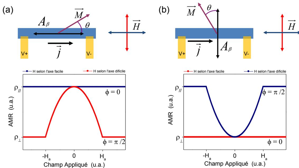
Lorsque le champ est appliqué perpendiculairement à l'axe d'anisotropie, la résistivité est minimale  $\rho_{\perp}$  pour  $H \leq -H_a$  car l'aimantation est alignée selon le champ appliqué et donc perpendiculaire au courant. A mesure que le champ diminue, de sorte que  $-H_a \leq H \leq 0$ , l'aimantation s'approche progressivement de l'axe d'anisotropie et la résistivité augmente. Cette évolution est donnée par l'expression suivante:
