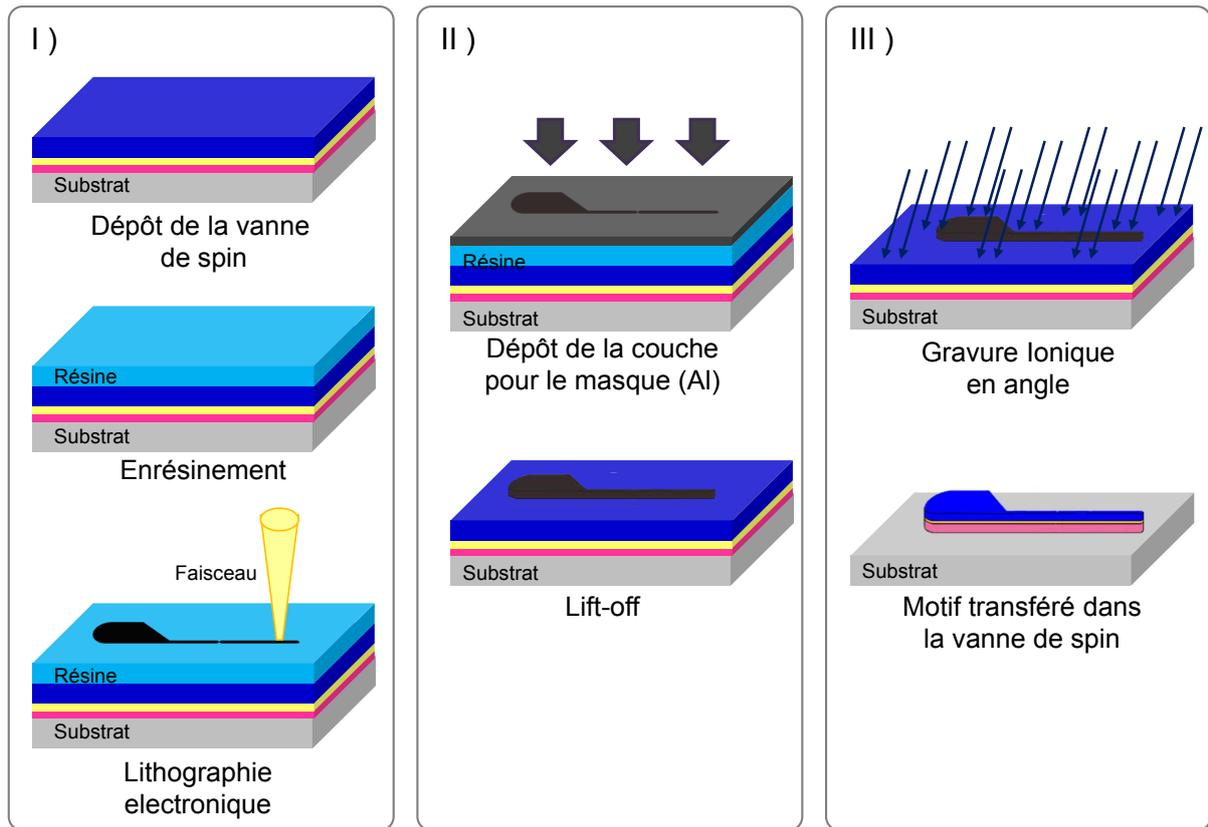
propagation d'une paroi de domaines. I) Définition du motif par lithographie électronique dans une couche de résine déposée sur la vanne de spin. II) réalisation du masque d'Aluminium par lift-off. III) Transfert du motif dans la vanne de spin par gravure ionique.
