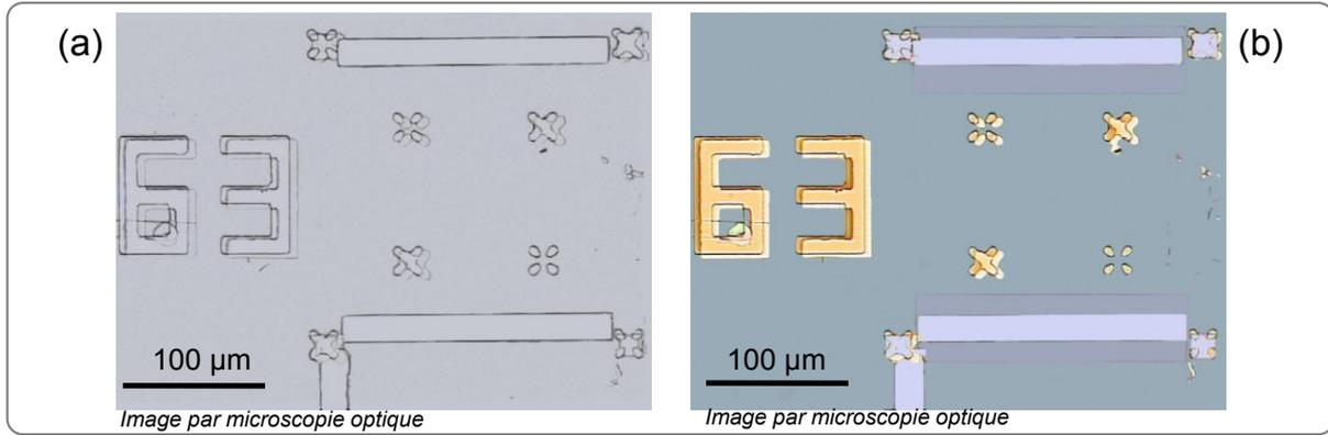
la formation d'un alliage avec le Si, une couche de Ta (5nm) est déposée en guise de buffer et pour éviter l'oxydation de la couche ferromagnétique, une couche de 3 nm de Pt est utilisée comme couverture.
