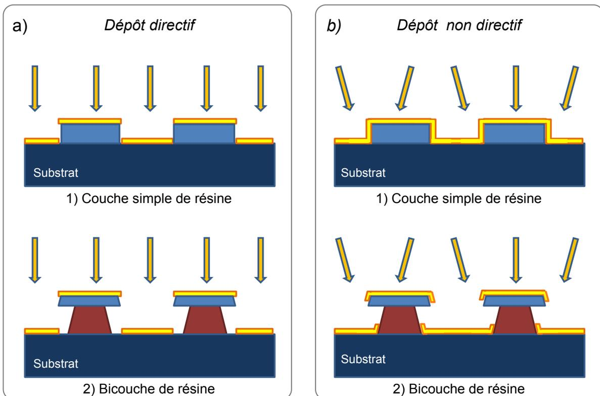
déposé, lorsque : a) le dépôt est directif, b) le dépôt est non directif. Les cas de 1) une couche simple de résine et de 2) une bicouche de résine sont montrés pour chaque type de dépôt.
