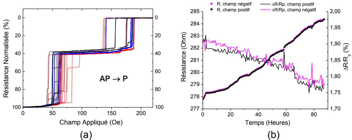
Sur la Fig. 4.36a, nous constatons que les courbes correspondant à des mesures non consécutives (de couleurs différentes), ne se superposent pas et semblent se décaler toujours dans le même sens au fil du temps (surtout pour la transition  $AP \rightarrow P$ ).
