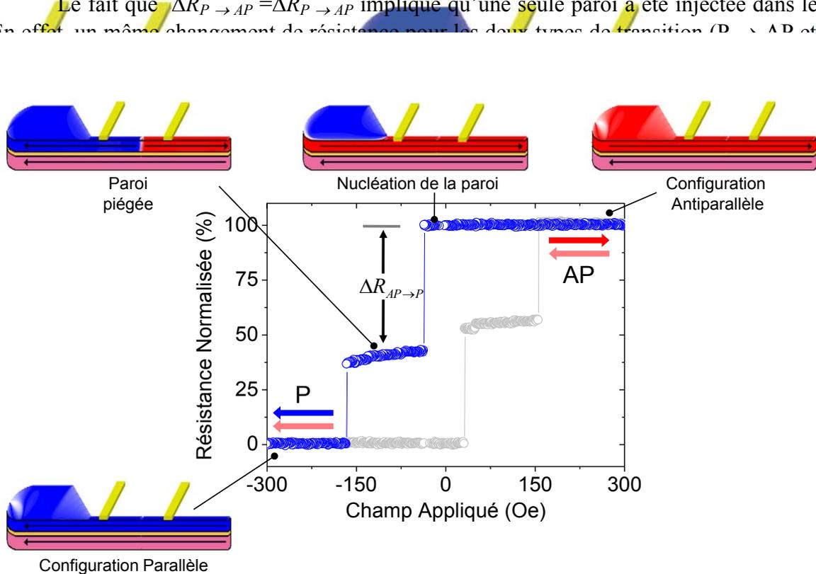
Cette fraction, de l'ordre de 60%, reflète la position de la constriction par rapport aux électrodes de mesure. De plus, puisque cette fraction se trouve du côté le plus proche du pad de nucléation, la variation de 60% implique aussi que la paroi a été injectée depuis le pad. Il faut souligner, enfin, que la direction de propagation de la paroi ne dépend pas du sens d'application du champ. En effet, la paroi se propage toujours du *pad* vers la constriction.
