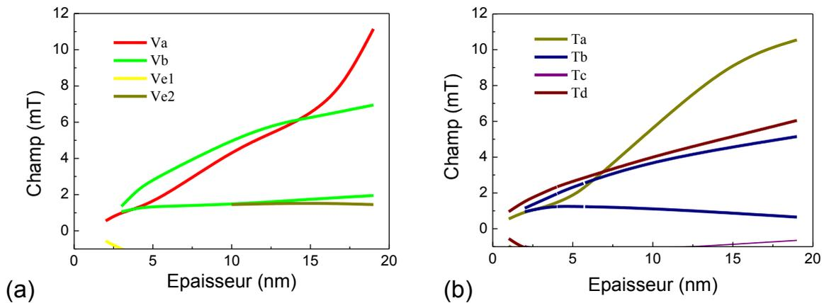
mécanisme de dépiéage différent selon l'épaisseur de la couche. Le type de mécanisme peut être déduit des courbes de la Fig. 4.15. Celles-ci représentent les domaines d'existence en champ des différentes configurations.
