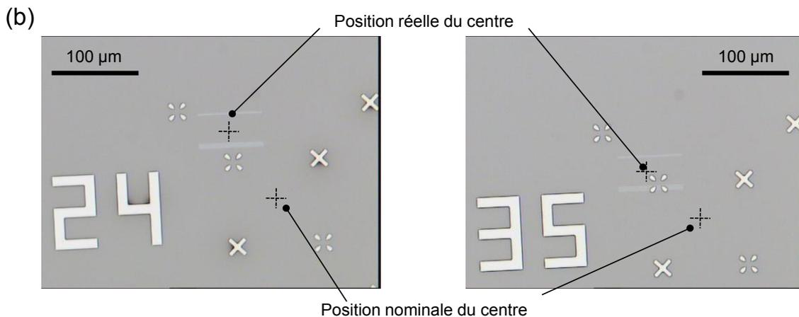
*système de croix x. b) Images par microscopie optique montrant le décalage entre les positions réelles et nominales du writefield pour deux expositions différentes du même motif.*
