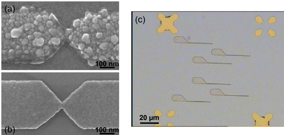
La présence des gros grains, notamment sur les bords, peut entraîner l'apparition d'effets de couplage. Ainsi, des faibles vitesses de dépôt ( $\sim 0,1$  Å/s) ont été utilisées pour réduire la formation de grains (Fig. 4.5b).
