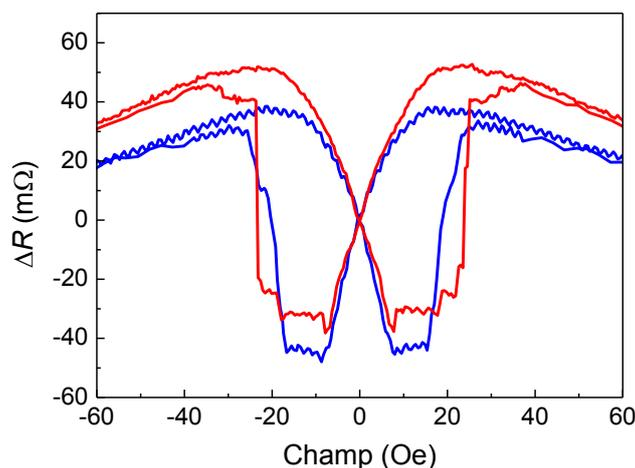
dû à des fuites de courant dans le substrat de silicium. Pour le premier échantillon étudié, cet offset est de l'ordre du signal mesuré. Une meilleure isolation du dispositif (couche isolante et/ou substrat moins conducteur) devrait permettre d'améliorer ce point.
