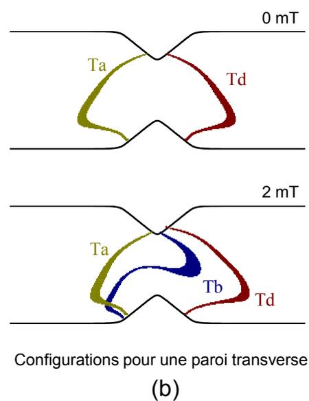
De manière similaire, les différentes configurations pour une paroi transverse sont montrées sur la Fig. 4.10b. On y trouve que 4 configurations sont possibles : Ta, Tb, Tc ("symétrique" de Tb) et Td. Dans la gamme de paramètres étudiée, les "extrémités" des parois sont toujours dans la constriction.
