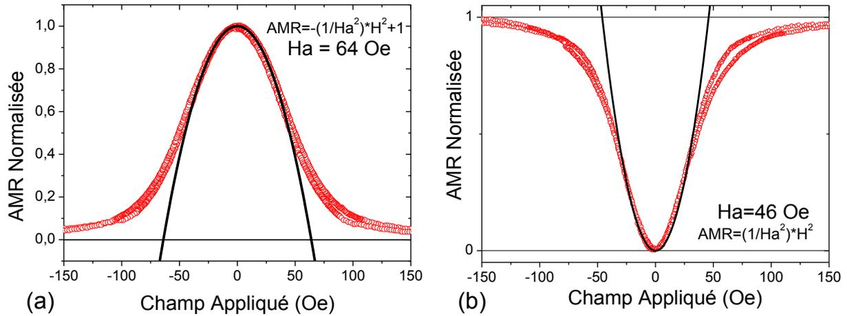
De cette façon il est possible de déterminer le champ d'anisotropie à partir des mesures d'AMR par ajustement à une parabole à de bas champs. Ainsi, lorsque les courbes sont normalisées à 1,
