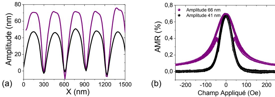
periode egale a 300 nm. L'amplitude moyenne de la modulation est 41 nm et 66 nm respectivement. Les cycles d'AMR correspondants sont présentés dans la Fig. 3.31b. On montre que plus l'amplitude de la modulation est grande, plus le champ pour mener le système à la saturation est grand. Ce dernier étant proportionnel à la constante d'anisotropie, elle sera plus grande à mesure que l'amplitude augmente.
