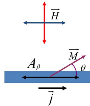
la présence d'une anisotropie uniaxiale orientée le long du barreau. Cette anisotropie, appelée par la suite *anisotropie intrinsèque*, est introduite lors du dépôt de la couche magnétique à cause du champ résiduel présent dans le bâti ou la géométrie du dépôt. Ne pouvant pas être éliminée ou contrôlée lors du dépôt, il faudra tenir compte de cette anisotropie lors de l'analyse de mesures d'AMR sur des dispositifs ayant une modulation.
