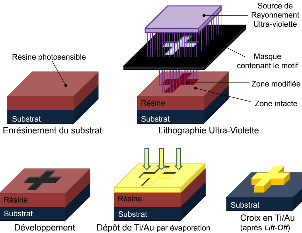
photosensible par lithographie optique (lithographie UV). Après le développement, le lift-off d'une couche de Ti/Au, déposée par évaporation, permet d'obtenir les croix sur le substrat.
