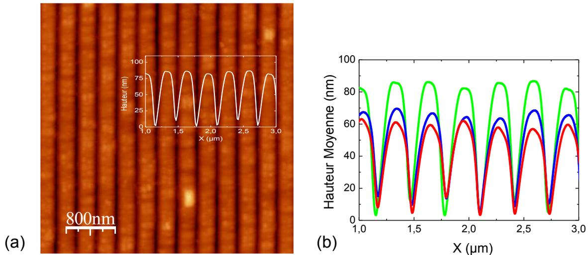
observé dans les images obtenues par AFM, ces bandes sont bien régulières et présentent bien la périodicité imposée par la lithographie électronique (Fig. 3.14). Dans la suite, nous allons regarder l'influence de cette modulation sur les propriétés magnétiques d'une couche magnétique déposée sur ce substrat à topologie modulée.
