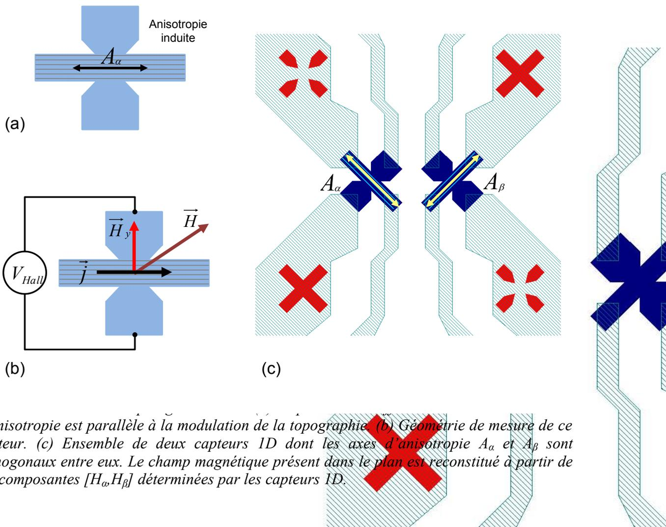
*d'anisotropie est parallèle à la modulation de la topographie. (b) Géométrie de mesure de ce capteur. (c) Ensemble de deux capteurs 1D dont les axes d'anisotropie  $A_\alpha$  et  $A_\beta$  sont orthogonaux entre eux. Le champ magnétique présent dans le plan est reconstitué à partir de ses composantes  $[H_\alpha, H_\beta]$  déterminées par les capteurs 1D.*
