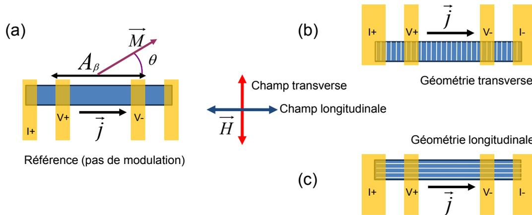
Nous allons maintenant aborder les résultats obtenus lors de la caractérisation par magnéto-transport des dispositifs réalisés à partir d'une surface modulée. Des mesures d'AMR ont été conduites sur trois types de dispositifs : deux présentant une modulation et un troisième n'en comportant pas. Ce dernier sera utilisé comme référence pour comparer les propriétés intrinsèques de la couche magnétique de celles obtenues grâce à la modulation.
