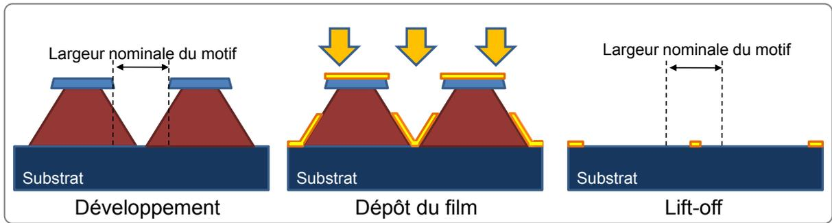
sur les flancs (Fig. 2.24). De cette façon, lorsque le lift-off sera effectué, la taille finale du motif sera plus petite que sa taille nominale. Un résultat similaire peut se présenter, même en appliquant des doses correctes pour l'exposition de la bicouche, si le temps du développement utilisé est inférieur au temps nécessaire pour dissoudre la totalité de la résine insolée, c'est-à-dire, lorsqu'il existe un sous-développement (Fig. 2.25a).
