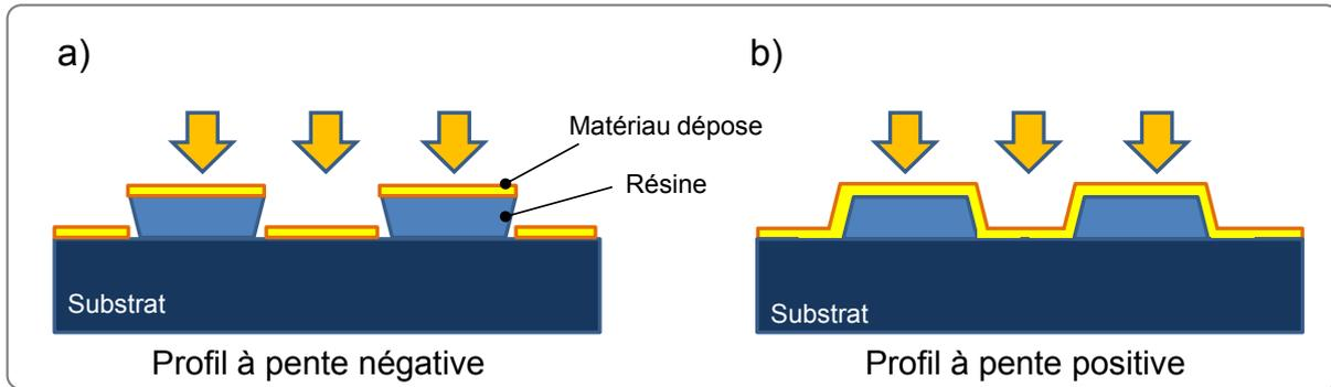
Les flancs de la résine doivent être inclinés de tel sorte que le matériau ne s’y dépose pas (Fig. 2.22a). En effet, si le matériau sur les flancs forme une couche continue avec le matériau en contact avec le substrat, les structures peuvent être endommagées au moment de la dissolution (Fig. 2.22b).
