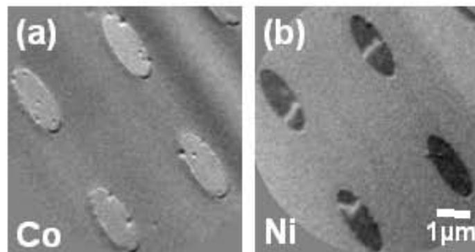
Fig. 5.4. Jonctions tunnel Co/Al<sub>2</sub>O<sub>3</sub>/NiFe sous forme d'ellipses. Image de microscopie de photo-électrons X obtenues au seuil d'absorption du Co (a) et au seuil d'absorption du Ni (b).
