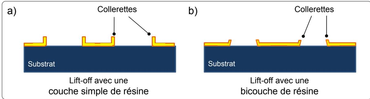
ainsi les collerettes. La Fig. 2.27 montre cette situation dans les cas d'une simple couche de résine (Fig. 2.27a) et d'une bicouche (Fig. 2.27b).
