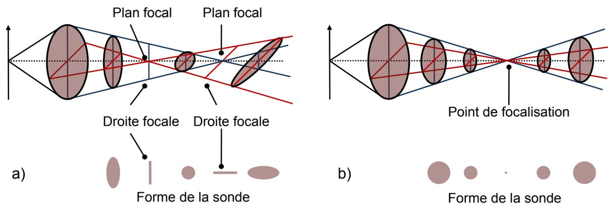
*minimum (qui dépend du demi-angle d'ouverture du faisceau). En dehors des trois points cités, le faisceau aura une forme elliptique. b) Changement de la forme du faisceau d'électrons en absence d'astigmatisme.*
