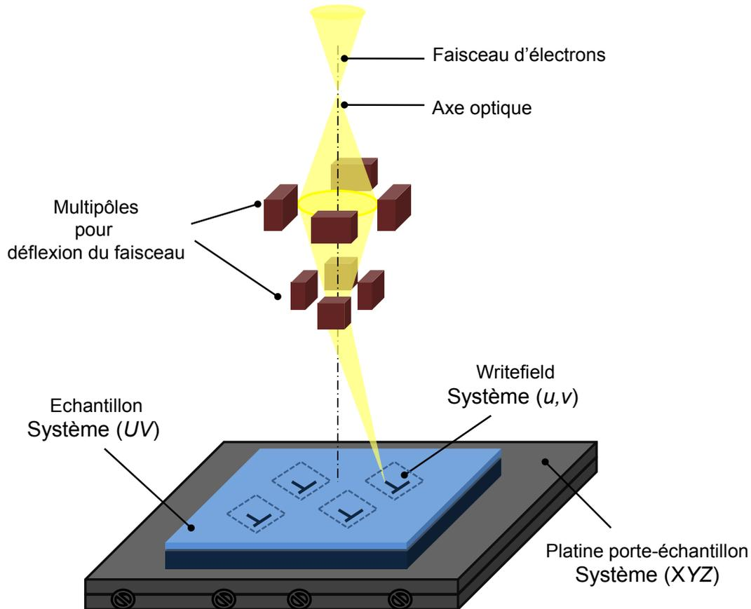
Fig. 2.17. Systèmes des coordonnées utilisés par le pilote de lithographie. Le système  $XY$  est associé au déplacement de la platine,  $Z$  étant parallèle à l'axe optique. L'échantillon se trouve dans le plan défini par les axes  $X$  et  $Y$ . Le système  $UV$  définit la position du writefield dans l'échantillon. Le système  $uv$  est associé à la position du faisceau dans un writefield fixe.
