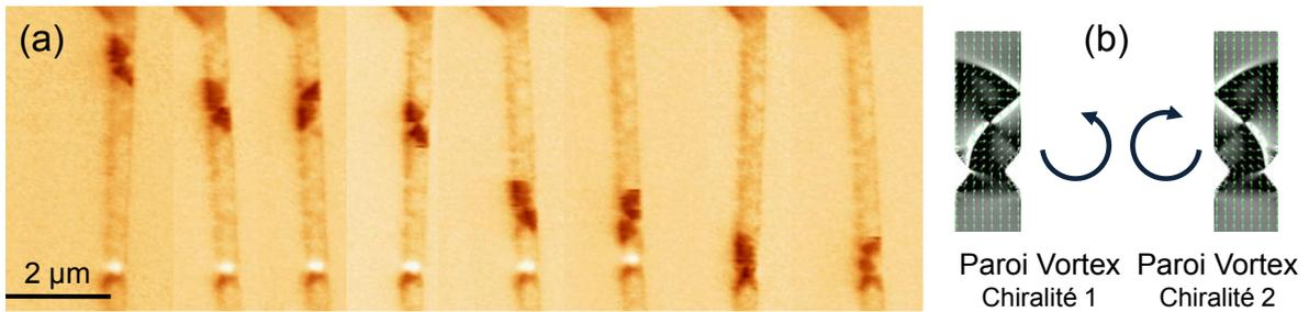
En outre, il est possible d'identifier le type de paroi observée. En effet, le contraste observé à l'AFM permet d'identifier la paroi par comparaison à la divergence de l'aimantation dans des configurations de parois connues (Fig. 4.25b). De cette façon, on trouve que la paroi observée est une paroi vortex. De plus, les deux chiralités possibles pour ce type de paroi sont observées.
