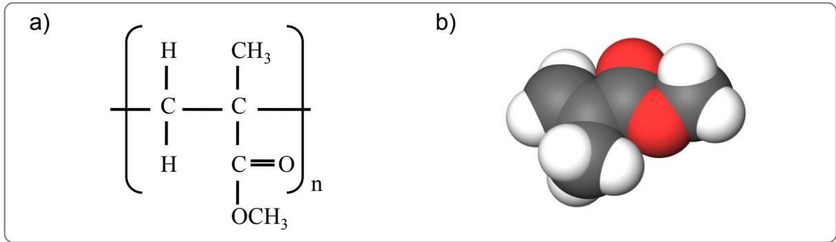
Elle est sensible aux électrons, la résine PMMA peut être aussi utilisée en photolithographie (DUV) et en lithographie par rayons X. Elle est très stable, très peu sensible à la lumière du jour et adhère parfaitement à de nombreux substrats. Par contre, elle a une faible résistance mécanique et, comme beaucoup de polymères hydrocarbonés, elle ne résiste pas bien aux environnements plasma.
