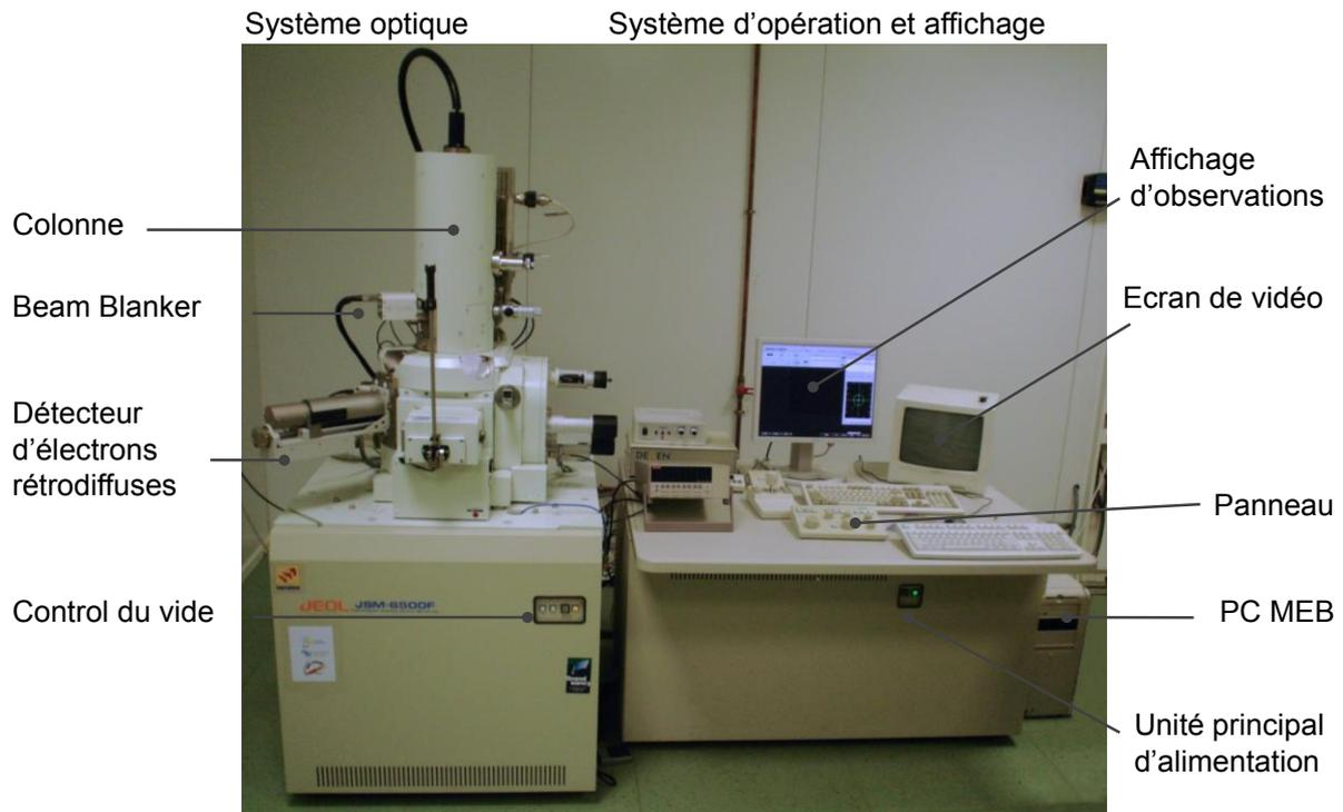
Le système de lithographie électronique utilisé au laboratoire est un système hybride, composé d'un microscope électronique à balayage JSM-6500F de JEOL, d'un module de pilotage du faisceau RAITH ELPHY Plus, ainsi que d'un module d'escamotage du faisceau d'électrons PCD Beam Blanker de DEBEN (Fig. 2.9).
