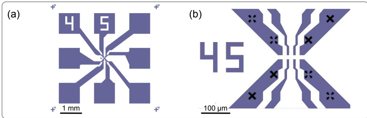
La lithographie optique de définition des électrodes est effectuée à l'aide d'un masque, nommé *EBeam3*, conçu pour être aligné aux marques présentes dans le masque utilisé pour la réalisation du système des croix d'alignement (*Ebeam1*). Le masque *EBeam3* contient dans chacune de ses cellules 8 électrodes dont 4 sont destinées au réseau supérieur et 4 au réseau inférieur (Fig. 3.17).
