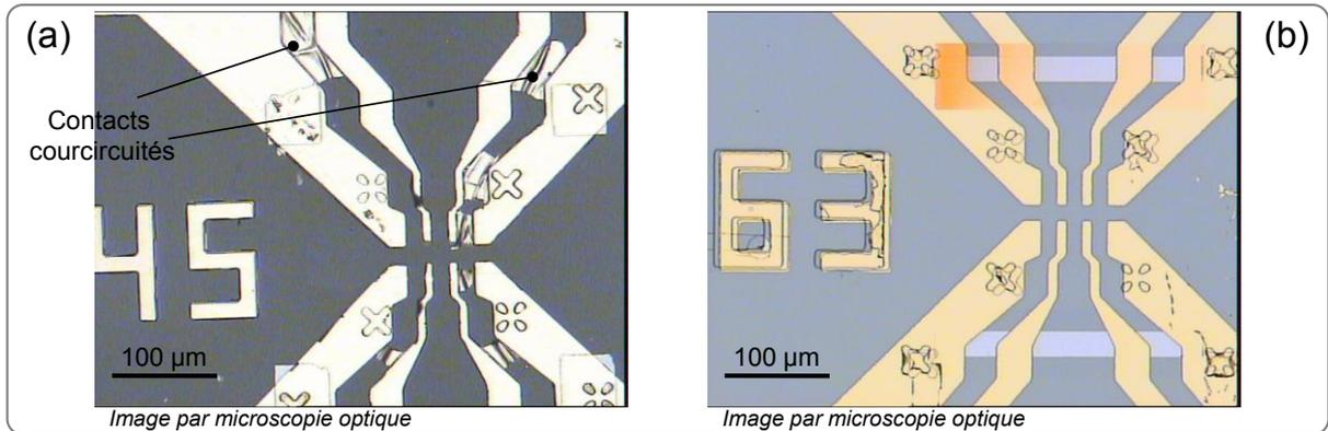
des contacts, cette dernière est gravée sur une couche au-dessous des électrodes. De manière similaire au cas de la réalisation des croix d'alignement, ces inconvénients peuvent être surmontés grâce à l'application d'un procédé de durcissement de la résine dont le résultat est l'obtention d'un profil dit de casquette, lequel facilitera le passage du solvant vers la résine.
