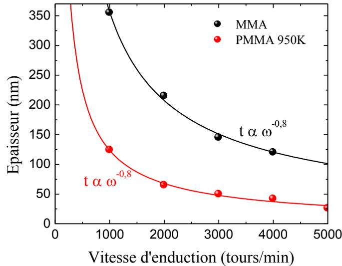
concentration de la résine et des conditions du dépôt par centrifugation. Cette épaisseur peut être exprimée d'une façon approximative par :
