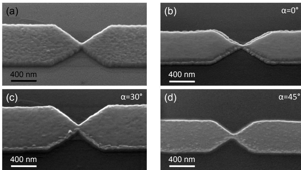
La Fig. 4.6 présente le profil du motif après gravure pour des différents angles d'incidence du faisceau d'ions. On y trouve que, en utilisant un angle d'incidence égale à  $45^\circ$ , les effets de redépôt sont minimisés.
