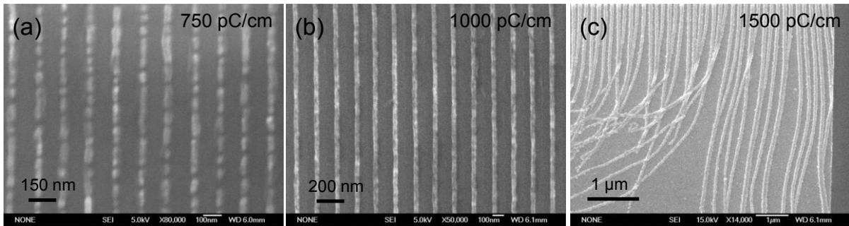
tomber dans deux cas extrêmes. D'une part, la dose fournie peu être la correcte pour développer la couche de MMA mais insuffisante pour une bonne exposition du PMMA (Fig. 3.12). D'autre part, une dose pour un PMMA bien exposé peut entraîner une surexposition du MMA, cette couche étant au-dessous de la bicouche, sa dissolution totale donne lieu à les structures *pont* ou de *nouilles* montrées sur la Fig. 3.12c. Un réseau bien exposé avec une dose égale à 1000 pC/cm est montré sur la Fig. 3.12b.
