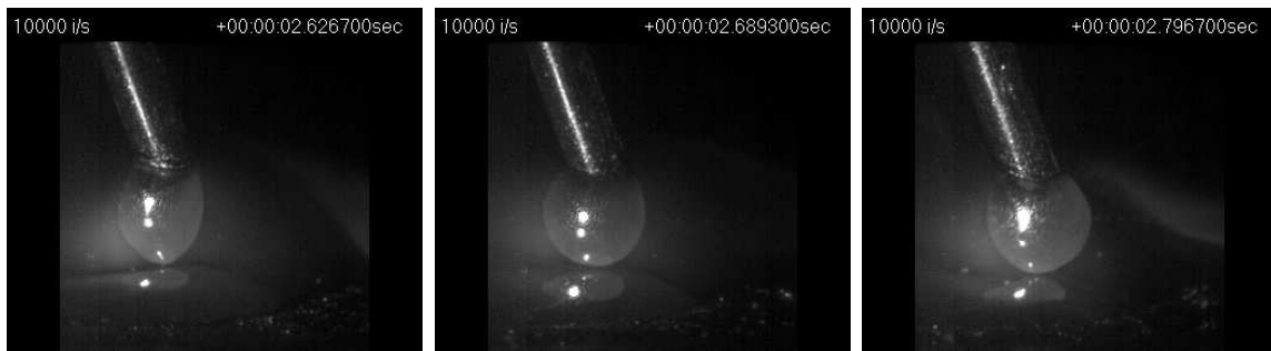
FIG. 4.31 – Images avant court-circuit avec S = 3 m/min et U_{oc} = 23 V.
