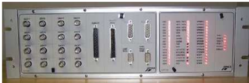
Fig. III.4. Panneau multi-entrées et multi-sorties.
